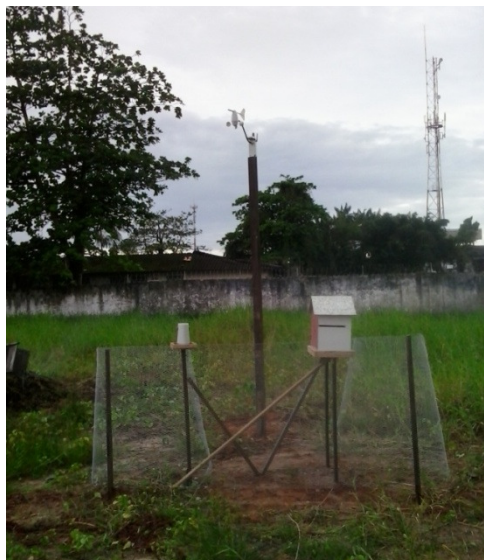
Figura 51 - Base da miniestação da Condor e os sensores instalados.
