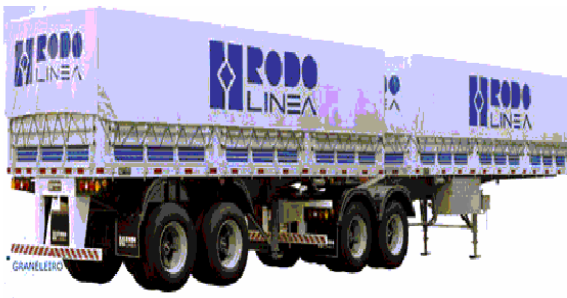
Figura 7. Semi-reboques graneleiros para o transporte de soja por rodovia. Fonte: (GRUPO HUBNER, 2006).
