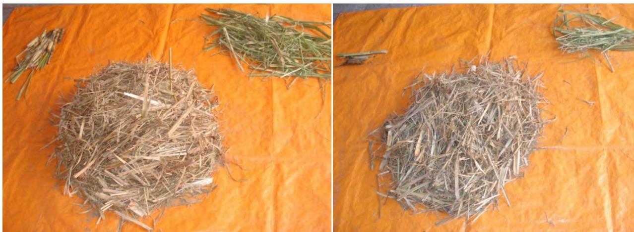
Figura 19 – Separação dos constituintes do palhiço em folhas secas, folhas verdes e material restante em cima de lona plástica.
