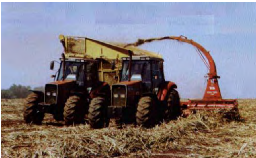
Figura 6 - Recolhedora de forragens recolhendo o palhiço enleirado. Fonte: Revista Ideanews (2002).
