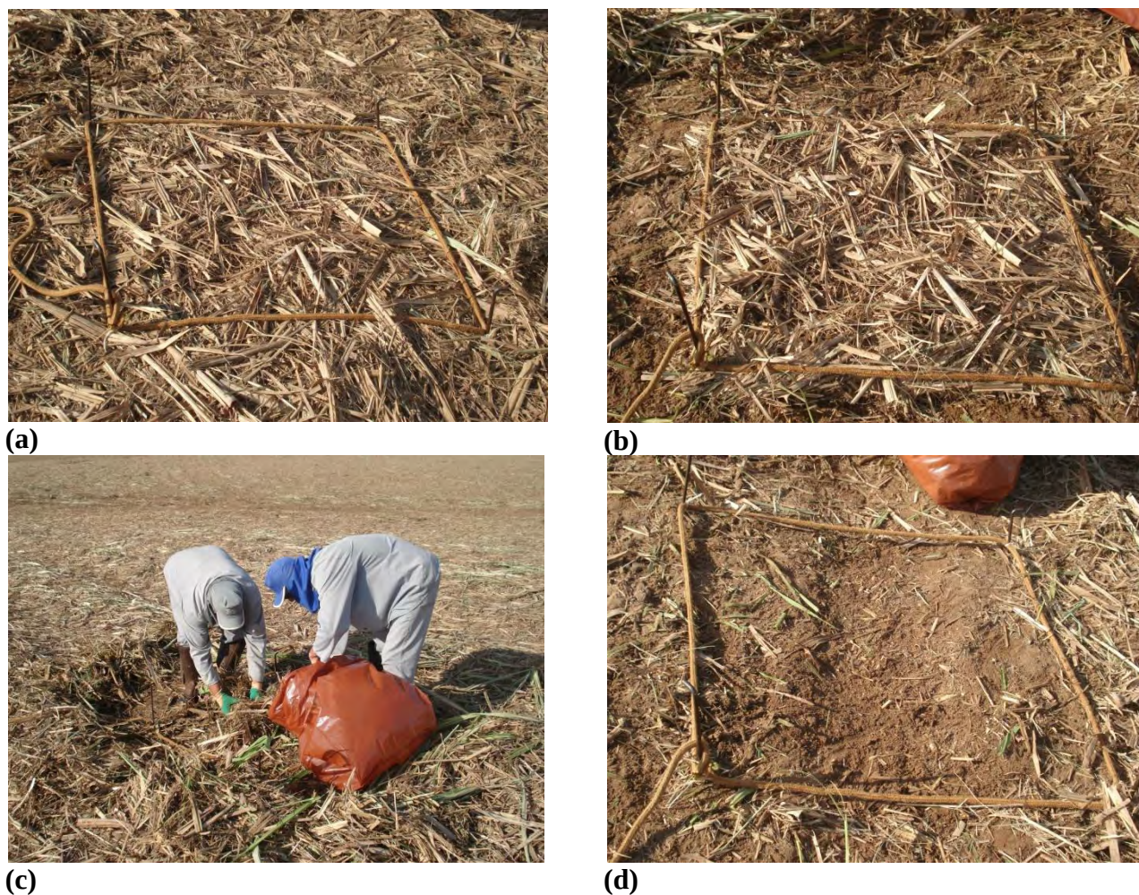
Figura 18 – Operação de recolhimento do palhiço: (a) gabarito de 1m 2 colocado sobre o palhiço, (b) corte lateral do palhiço, (c) recolhimento do palhiço contido dentro do gabarito, (d) solo limpo, final da operação.
