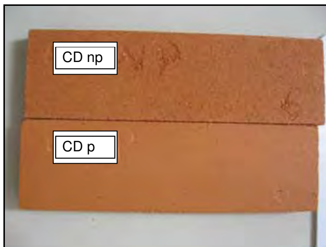
Figura 36. Corpos de prova queimados à temperatura de 925°C mostrando diferente densificação entre as amostras plástica e não plástica.
