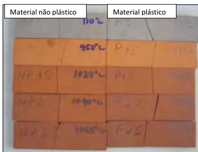
Figura 34. Foto dos corpos de prova plásticos e não plásticos evidenciando a retração maior entre as peças queimadas à temperatura acima de 1000°C.
