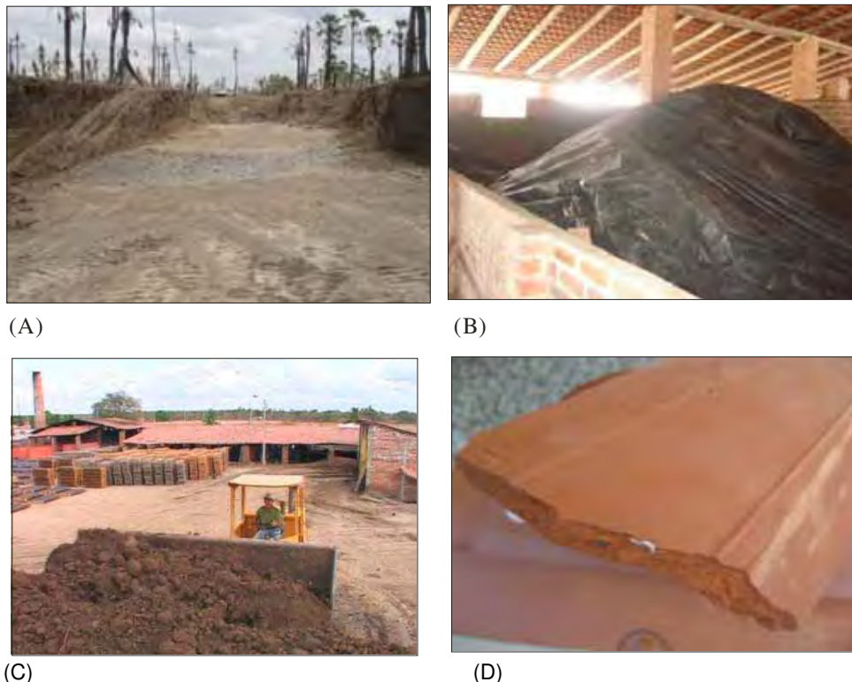
Figura 7. (A) área de exploração da matéria-prima; (B) etapa de sazonalamento do material nos galpões cobertos por lonas; (C) Fase de preparação e homogeneização da massa e (D) Defeito na telha provocado pelo aparecimento de partículas de calcário.
