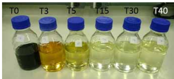
Figura 60: Amostras de tratamento eletrolítico de mistura de corantes Acid Blue 40 e Acid Red 151 em diferentes tempos com concentração de 10,00 g/L de cloreto de sódio e 1,32 g/L de carbonato de sódio. Como os mostrados acima dos frascos, T0 é o controle, T3 foi o de 3 min de tratamento eletrolítico, T5 foi de 5 min de tratamento eletrolítico, e assim sucessivamente. Fonte: o autor.
