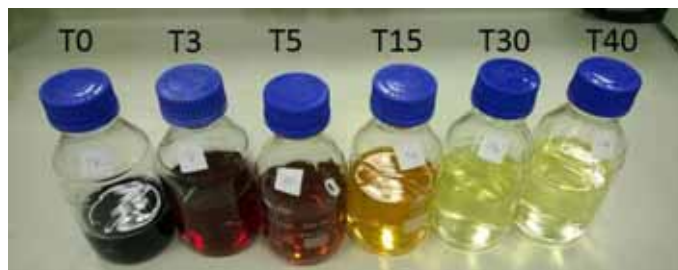
Figura 63: Amostras de tratamento eletrolítico de mistura de corantes Acid Blue 40 e Acid Red 151 em diferentes tempos com concentração de 2 g/L de cloreto de sódio e 0,26 g/L de carbonato de sódio. Como os mostrados acima dos frascos, T0 é o controle, T3 foi o de 3 min de tratamento eletrolítico, T5 foi de 5 min de tratamento eletrolítico, e assim sucessivamente. Fonte: o autor.
