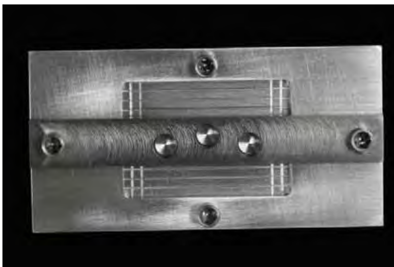
Figura 9 - Conjunto de matrizes compensada, caracterizada pelo deslocamento de cilindro central.
