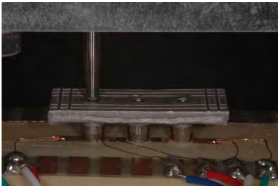
Figura 24 – Detalhe do carregamento vertical estático, sobre o ponto de aplicação de carga A, no modelo experimental linear.
