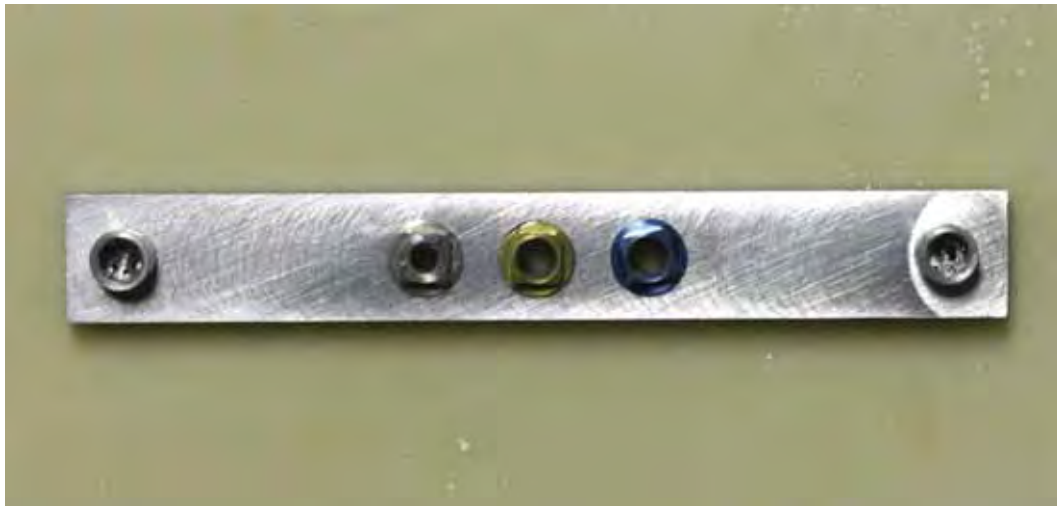
Figura 10 - Componente 3 fixado por parafusos verticais no bloco de poliuretano e associado aos anéis rosqueáveis, posicionamento linear.
