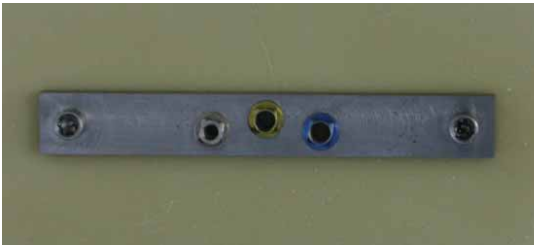
Figura 11 - Componente 3 fixado por parafusos verticais no bloco de poliuretano e associado aos anéis rosqueáveis, posicionamento compensado.
