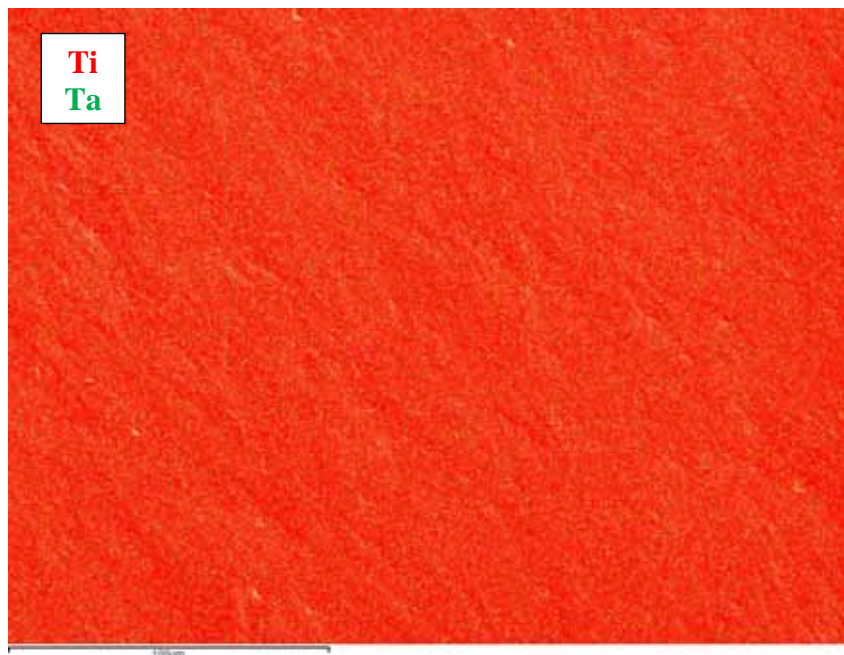
Figura 33 - Mapeamento dos elementos titânio e tântalo para a amostra da liga Ti-19Ta, , realizado por 60 minutos.
