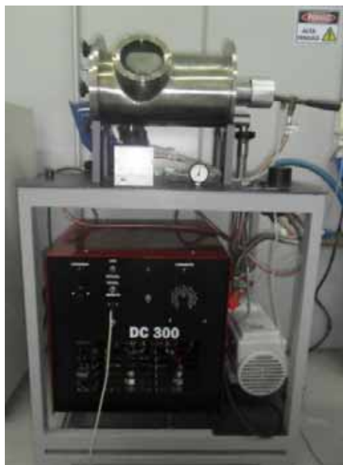
Figura 9 – Forno de fusão a arco voltaico.
