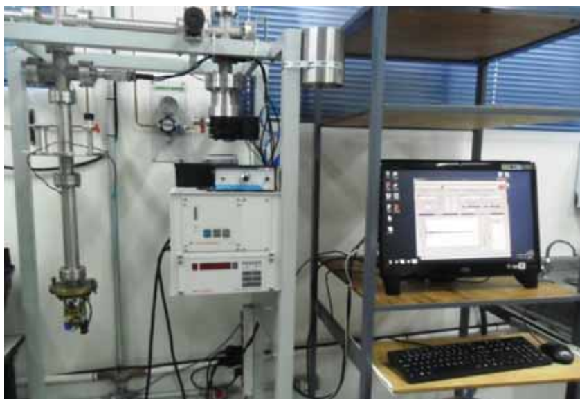
Figura 28 – Fotografia do sistema Sonelastic®.
