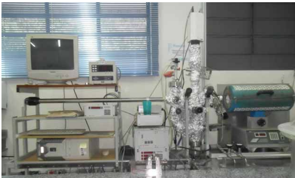
Figura 13 – Sistema de tratamento térmico utilizado.
