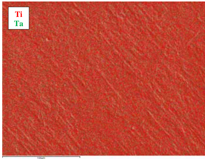
Figura 32 - Mapeamento dos elementos titânio e tântalo para a amostra da liga Ti-23Ta, , realizado por 30 minutos.
