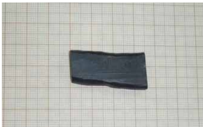
Figura 34 – Camada de óxido formada na superfície das amostras.
