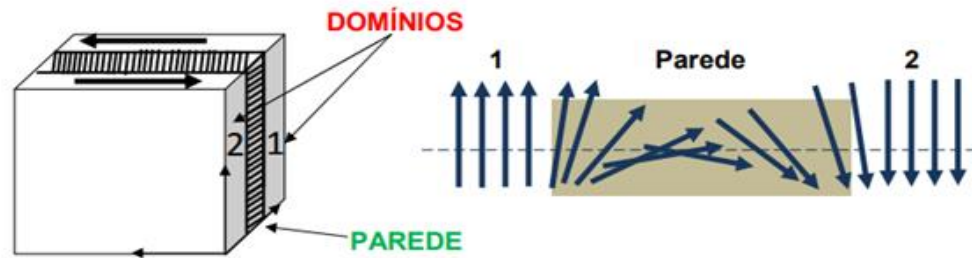
Figura 14: Ilustração mostrando dois domínios com magnetização antiparalela separada por uma parede de Bloch.
