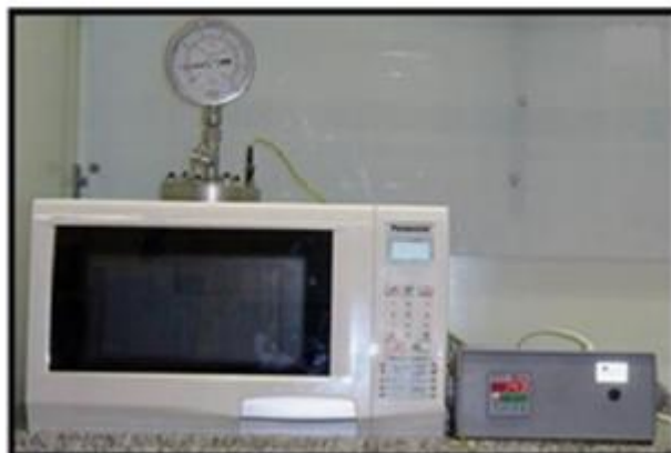
Figura 27: Equipamento hidrotermal micro-ondas que atinge 150°C.
