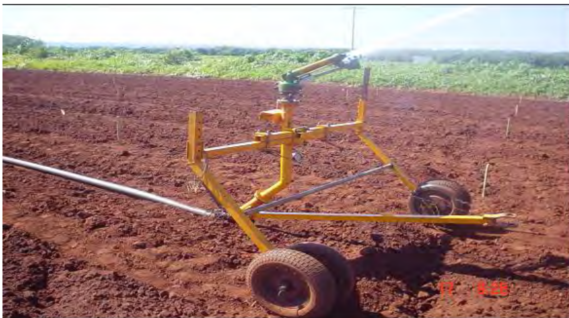
Figura 5: Deslocamento longitudinal do autopropelido ao longo da área a ser irrigada
