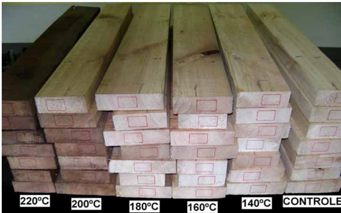
Figura 10. Aspecto visual de peças de madeira de E. grandis termorretificadas nas diferentes temperaturas adotadas no estudo e demarcação prévia (em vermelho) da região de retirada dos corpos-de-prova.
