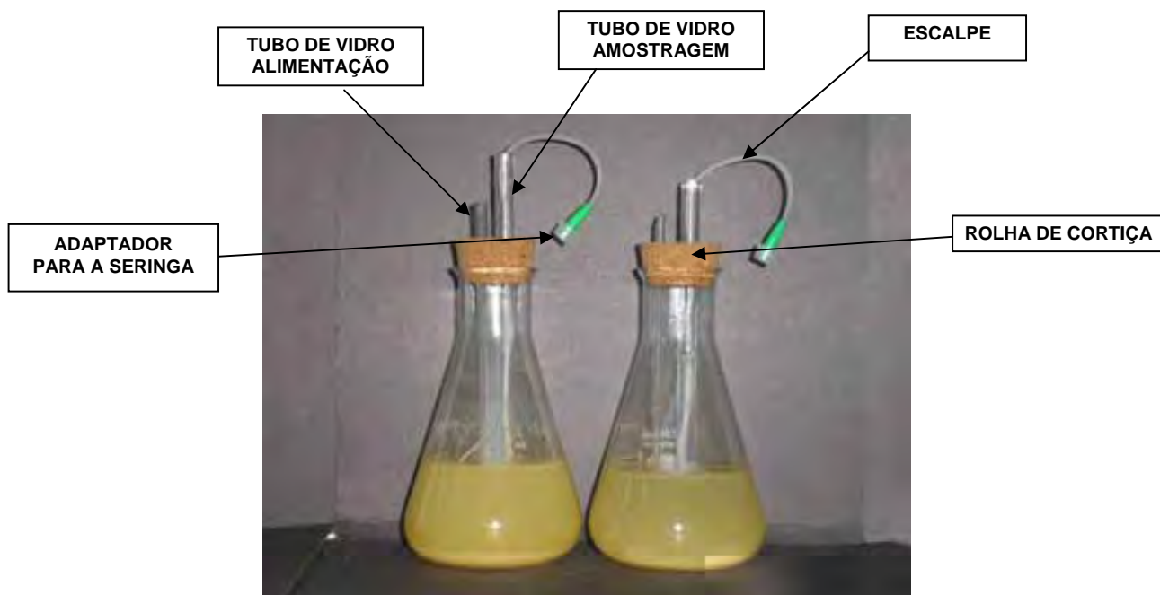
Figura 5 – Figura representativa dos frascos adaptados usados nos ensaios B e C
