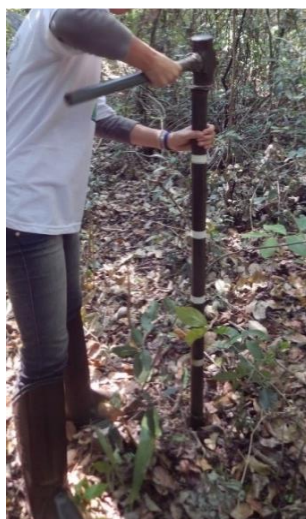
Figura 6 - Trado modificado utilizado para coleta das amostras de solo
