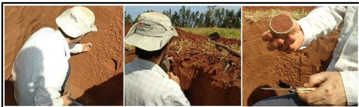
Fotografia 2 – Coleta dos anéis volumétricos na trincheira
