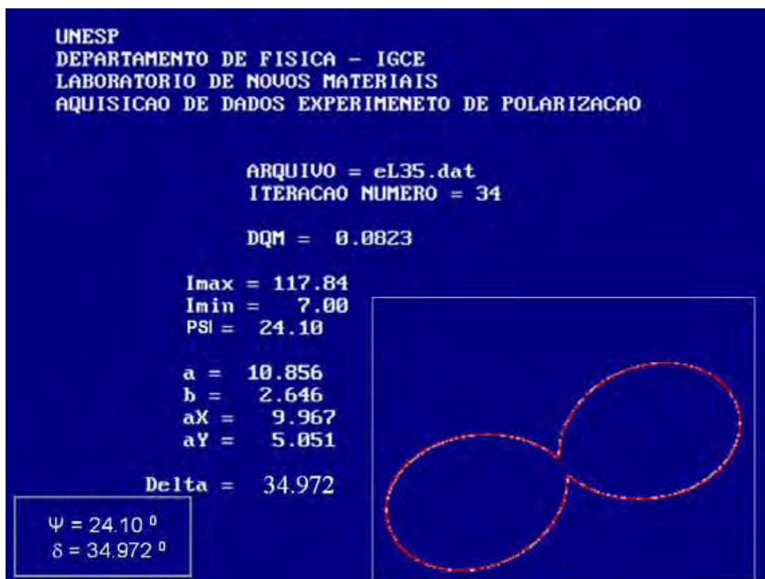
Figura 57. Aspecto da tela do programa de ajuste da função aos pontos experimentais e dos cálculos dos ângulos elipsométricos ( \Psi e \delta ). Nessas primeiras simulações os dados gerados para o ajuste eram teóricos a fim de se conferir a exatidão dos mesmos e corrigir eventuais erros nas formulas.
