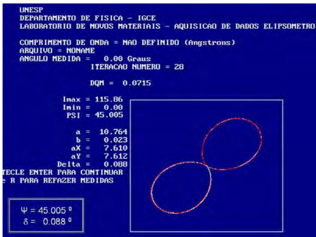
Figura 59. Aspecto da tela do programa de aquisição de dados e juste da função para os pontos experimentais para uma luz linearmente polarizada à 45^\circ , como mostra os valores dos ângulos elipsométricos ( \Psi = 45.005^\circ e \delta = 0.088^\circ ).
