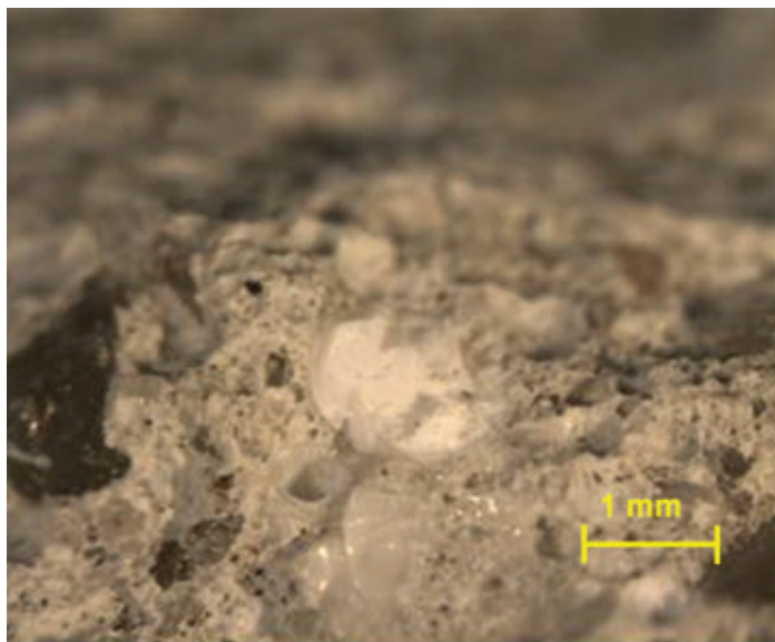
Figura 2.6. Concreto com RAS observado no Microscópio Ótico.
