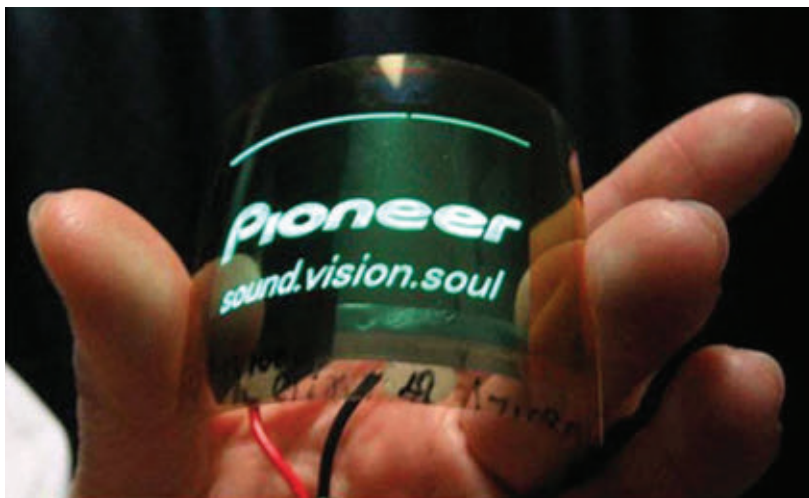
Figura 4. Luminescência de um OLED depositado sobre um nanocompósito flexível a partir de nanofibras de celulose provenientes de madeira. 3
