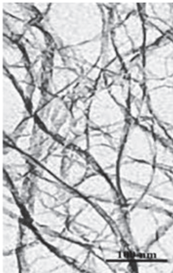
Figura 5. Imagem de microscopia de transmissão de nanowhiskers obtidos da fibra de coco (Leão et al. 2010).
