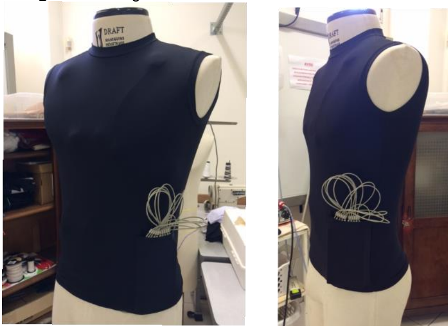
Figura 34 - Regata com eletrodos fixados e bolso lateral
