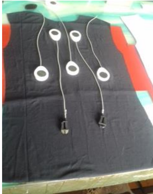
Figura 33 - Desenvolvimento de silicone condutivo 1
