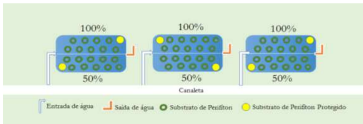
Figura 2. Esquema dos viveiros escavados utilizados para o experimento.
