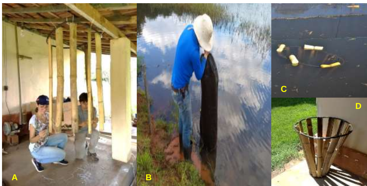
Figura 3. Módulos utilizados durante o experimento. A - Confecção dos módulos de bambu; B - Módulo protegido com sombrite; C - Módulo com flutuadores no local do experimento; D - Módulo montado.
