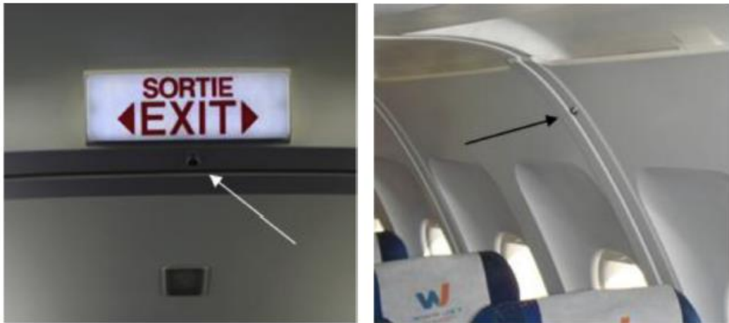
Figuras 9 e 10 – Posição do sensor no teto da cabine / Posição do sensor na parede da cabine
