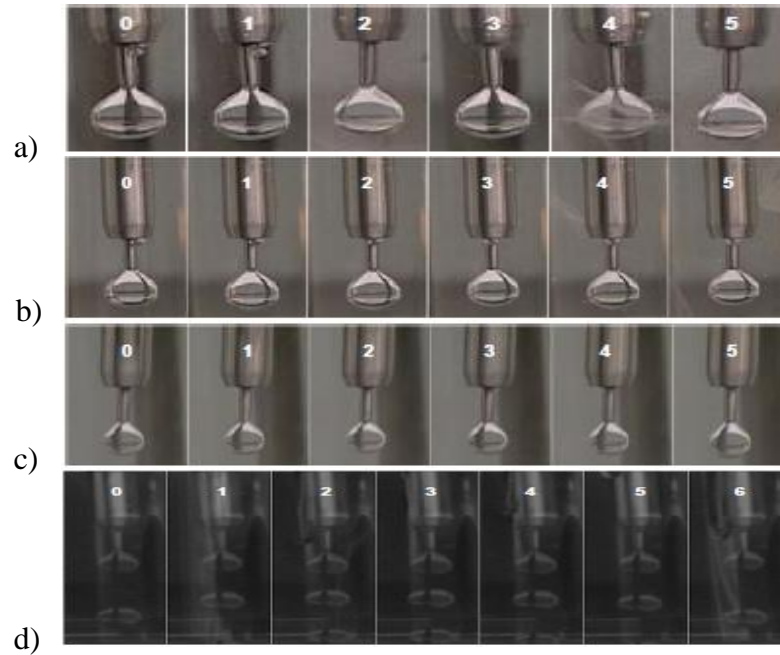
Figura 6 - Foto do experimento de gota pendente: a) óleo mineral leve, b) óleo mineral pesado, c) querosene e d) N350.
