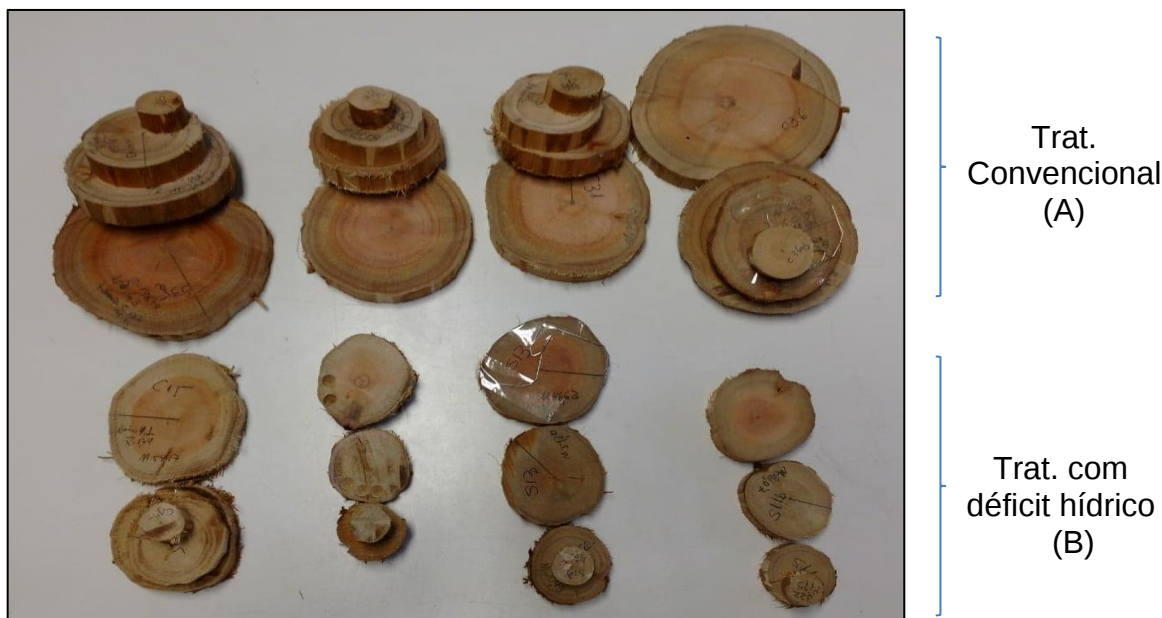
Figura 1 - Discos serrados e com espessura uniforme de Eucalyptus grandis . Dados: amostras clonais de 12,5 a 87,5% da altura comercial; Figura (A) – Amostras obtidas no tratamento convencional; Figura (B) - Amostras obtidas no tratamento com déficit hídrico
