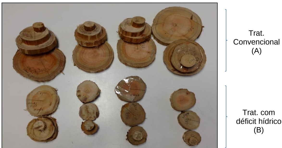
Figura 1 - Discos serrados e com espessura uniforme de Eucalyptus grandis . Dados: amostras clonais de 12,5, 37,5, 62,5 e 87,5% da altura total; Figura (A) – Amostras obtidas no tratamento convencional; Figura (B) - Amostras obtidas no tratamento com déficit hídrico
