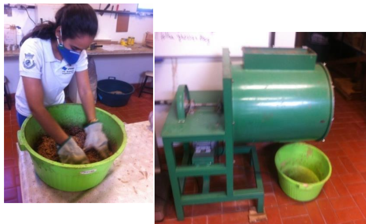
Figura 26 - Adição e homogeneização do adesivo e misturador de tambor
