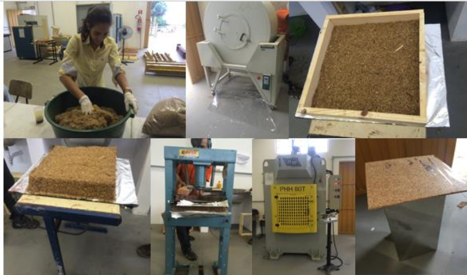
Figura 37 – Processo de confecção dos painéis ajustados 50% serragem e 50% bagaço de cana
