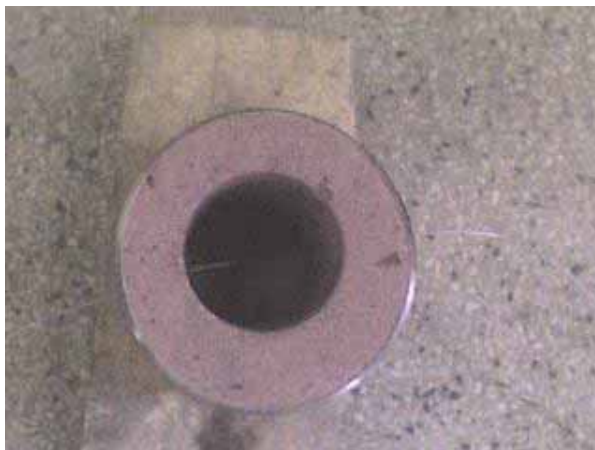
Figura 21 Disposição dos termopares no molde de areia para a fundição da liga de Al-Si AA 356.0.
