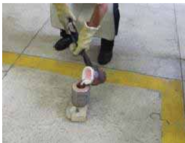
Figura 15 Fundição da liga AA 356.0 no molde de areia.
