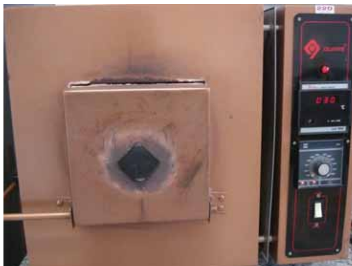
Figura 11 Forno utilizado para a fundição das peças no molde metálico e de areia.
