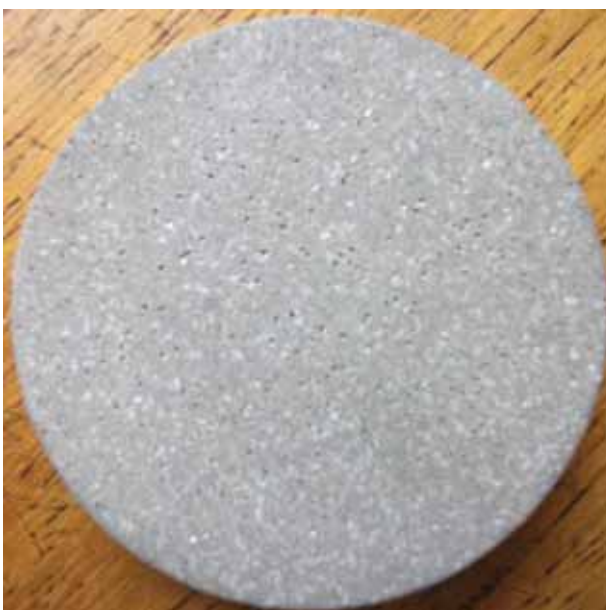
Figura 33 Macroestrutura da liga AA 356 com adição do refinador de Al-Ti-B.
