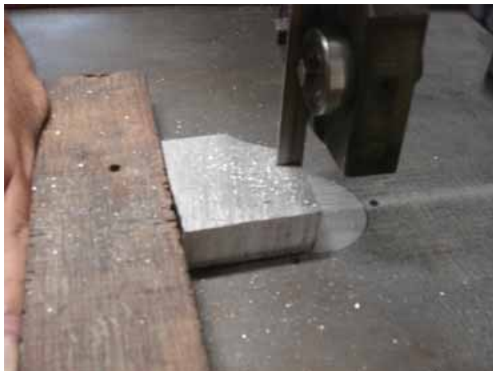
Figura 9 Serra fita utilizado para cortar os pedaços da liga de alumínio AA 356.0.
