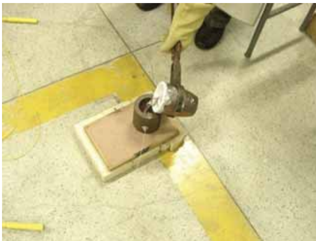
Figura 13 Fundido da liga AA 356.0 sendo vazado no molde metálico.
