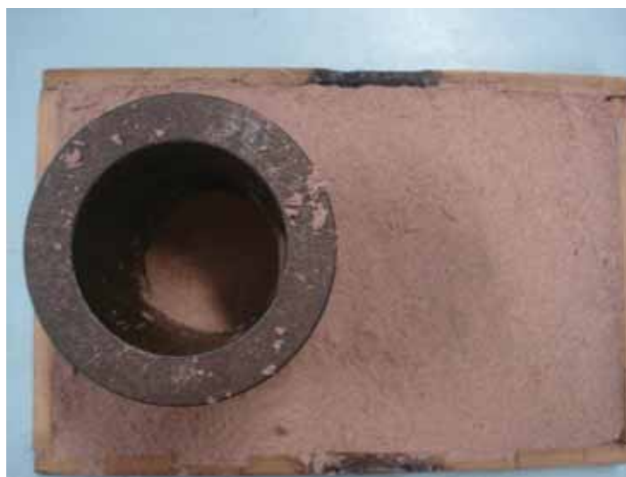
Figura 12 Preparação do molde metálico com fundo de areia de fundição.
