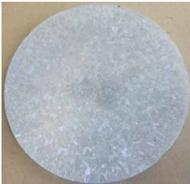
Figura 16 Macroestrutura obtida com a amostra de liga de alumínio AA 356.0 fundida em molde metálico.
