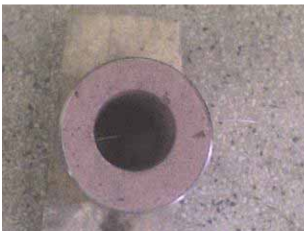
Figura 14 Configuração do molde de areia.
