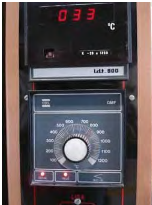
Figura 10 Visor do forno de aquecimento programado para derreter a liga AA 356.0.
