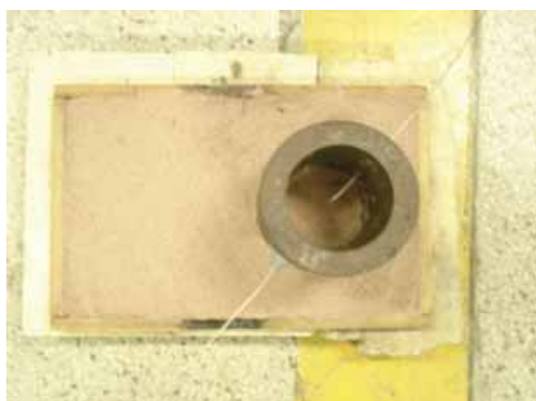
Figura 22 Disposição dos termopares no molde permanente metálico usado na fundição da liga AA 356.0.
