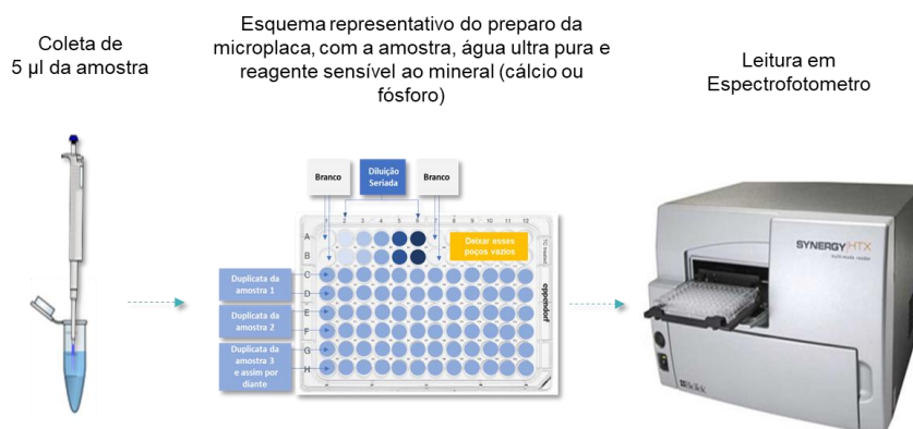
Figura 9 – Esquema da coleta das amostras no tubo Eppendorf até o posicionamento no leitor de microplacas
