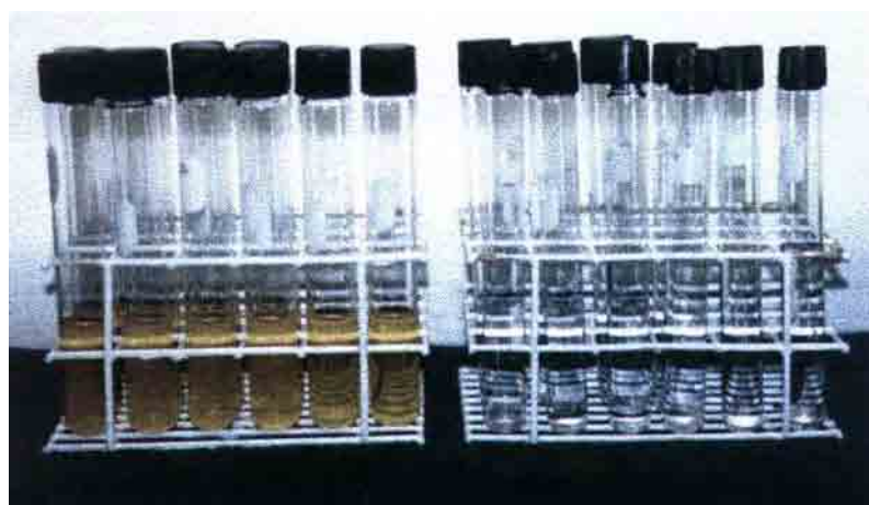
Figura 11 – Tecnologia do substrato cromogênico ONPG empregando a Técnica de Tubos Múltiplos
