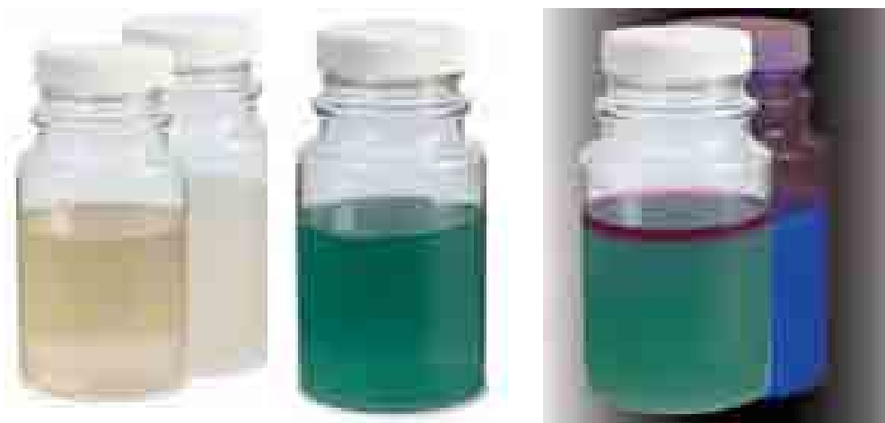
Figura 10 – Mudança de coloração na reação enzimática X-GAL/MUG (MERCK, 2005)
