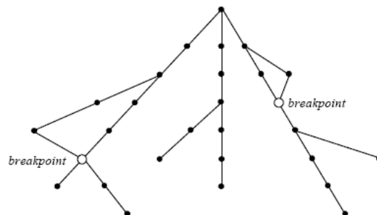
Figura 3.3. Rede de distribuição fracamente malhada.
