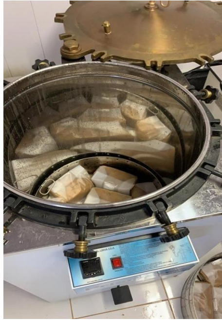
Legenda: Blocos prensados e suplementados prontos para esterilização em autoclave. Fonte: Dados do próprio autor
