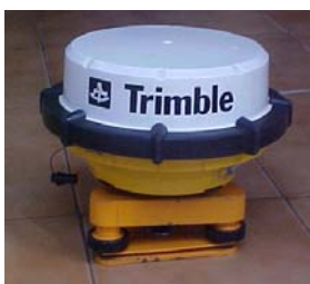
FIGURA 16 - Receptor Trimble 4600 LS utilizado no levantamento
