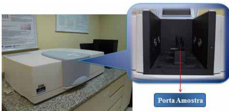
Figura 18: Fotografia do espectrômetro Uv-Vis-NIR modelo Lambda 750 da marca Perkin Elmer utilizado nas medidas de transmitância óptica.
