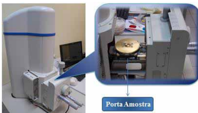
Figura 17: Fotografia do Microscópio Eletrônico de Varredura (MEV) com EDS acoplado para a identificação da composição química do material.
