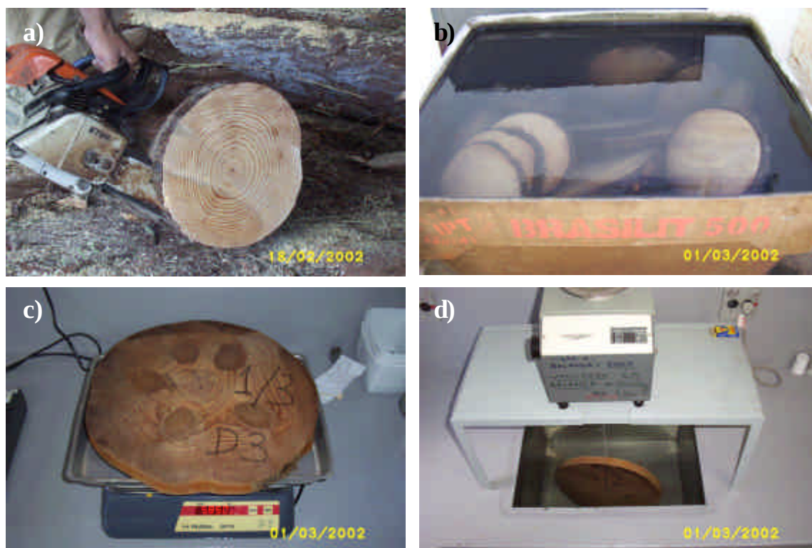
Figura 10 – a) Retirada dos discos de Pinus taeda para os cálculos de umidade e densidade básica; b) discos completamente submersos, indicativo que atingiram saturação; c) pesagem do disco saturado “ao ar” e d) pesagem hidrostática do disco
