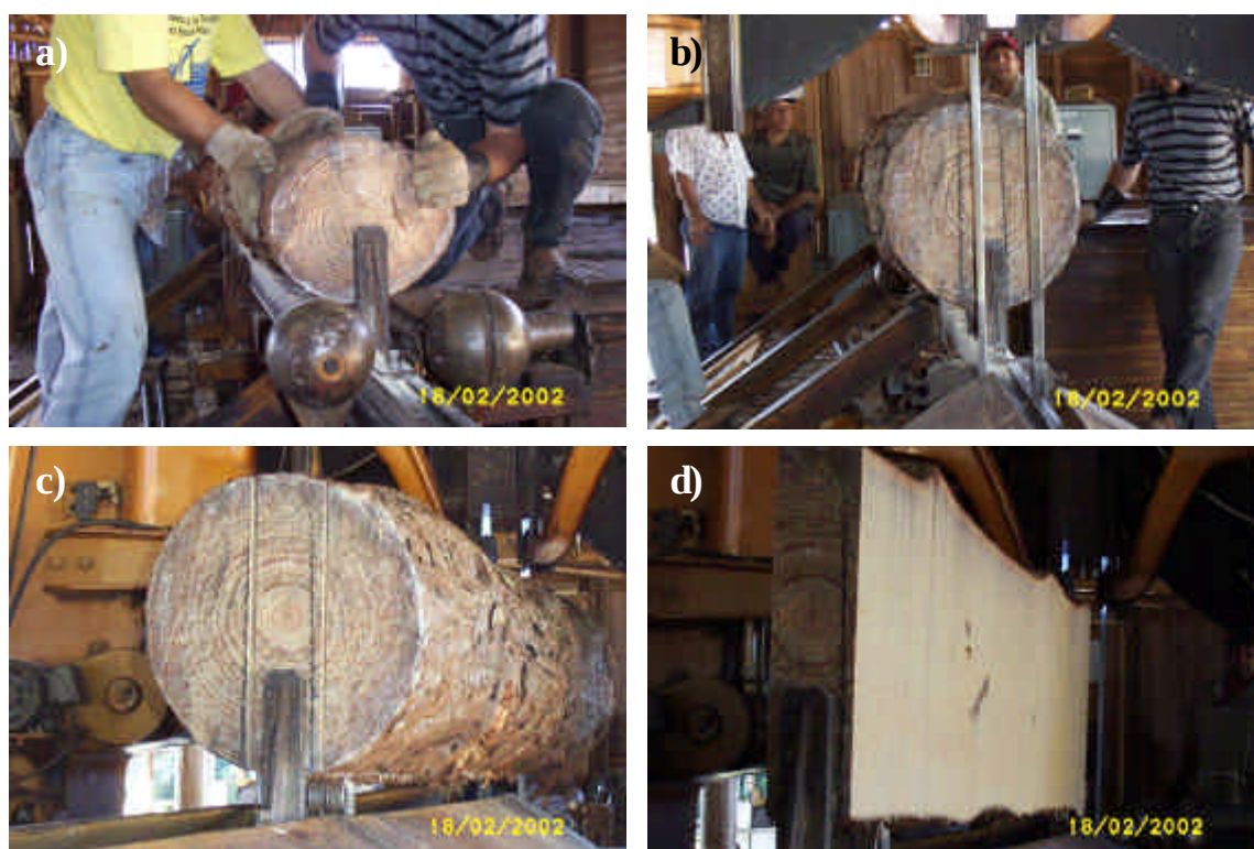
Figura 13 – Desdobro das pranchas centrais da tora. a) fixação da tora pelo menor diâmetro; b) detalhe da serra-fita; c) processamento mecânico da prancha e d) conformação final da prancha.
