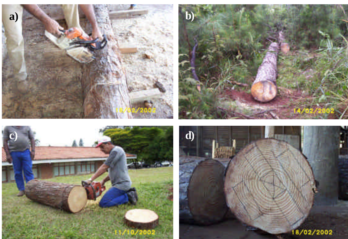
Figura 11 – a) e b) Desdobro das toras em duas porções distintas de 1,25m e 2,50m a partir da base para a confecção dos corpos-de-prova; c) processamento das toras em discos para confecção dos corpos-de-prova radiais e tangenciais e d) tореte destinado à confecção dos corpos-de-prova longitudinais.
