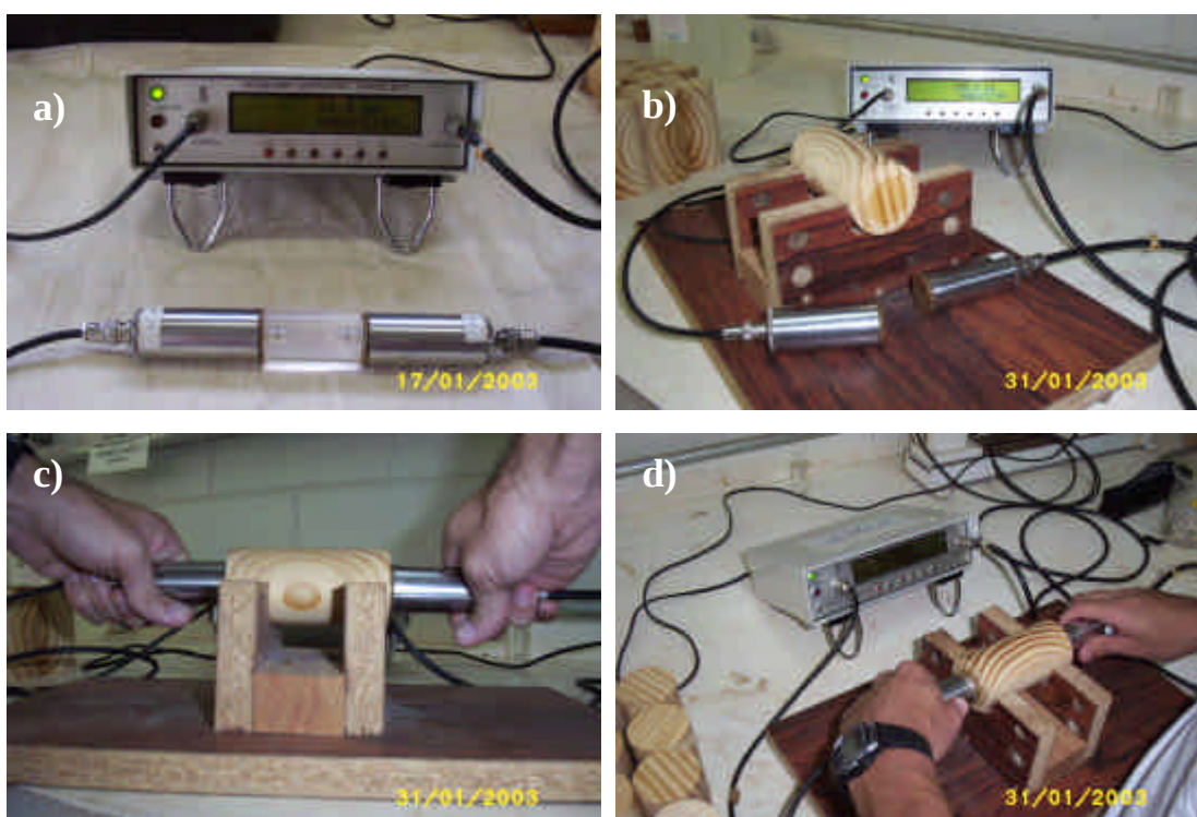
Figura 31 – Execução do ensaio de ultra-som nos corpos-de-prova tangenciais. a) calibração do aparelho Steinkamp BP-7; b) aplicação da camada de gel medicinal; c) e d) obtenção da leitura do tempo de propagação da onda ultra-sonora.
