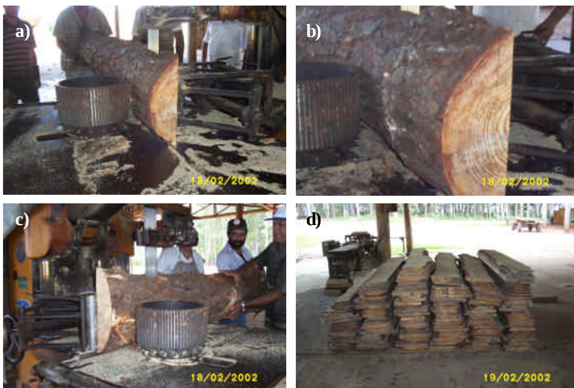
Figura 14 – a) desdobro das tábuas a partir das costaneiras laterais das toras; b) detalhe da costaneira; c) processamento mecânico das tábuas e d) vista geral do lote de tábuas.
