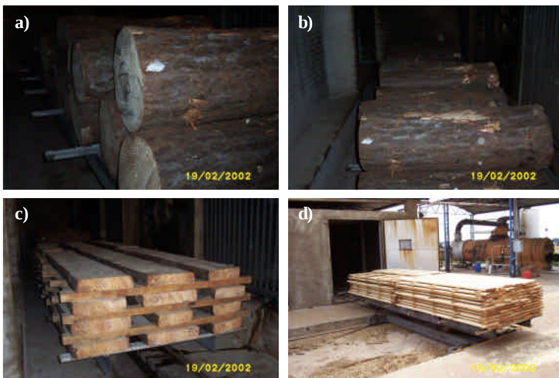
Figura 15 – a) detalhe dos toretes destinados à confecção de discos e, posteriormente, corpos-de-prova radiais e tangenciais; b) vista geral dos toretes dentro da câmara de secagem; c) pranchas submetidas ao processo de secagem industrial e d) tábuas sendo introduzidas na câmara de secagem.
