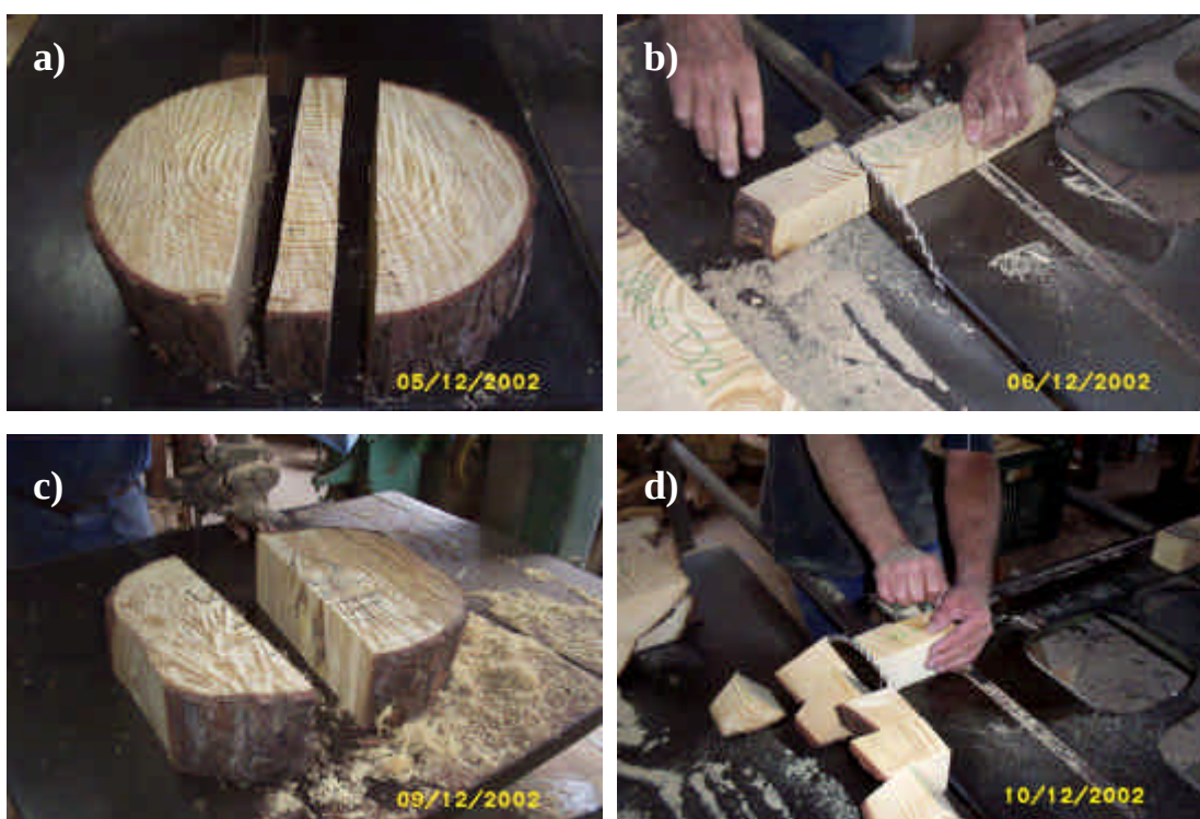
Figura 29 – Preparação dos discos para confecção dos corpos-de-prova tangenciais. a) descarte da região medular para confecção dos corpos-de-prova de madeira juvenil; b) acerto das faces do bloco de madeira juvenil e c) descarte da região da casca para a confecção dos corpos-de-prova de madeira adulta e d) acerto das faces do bloco de madeira adulta.
