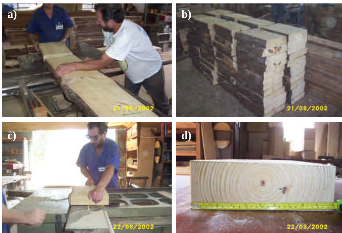
Figura 19 – a) Desdobro das pranchas em 4 partes iguais; b) vista geral após processamento; c) descarte da casca e d) configuração final da prancha.
