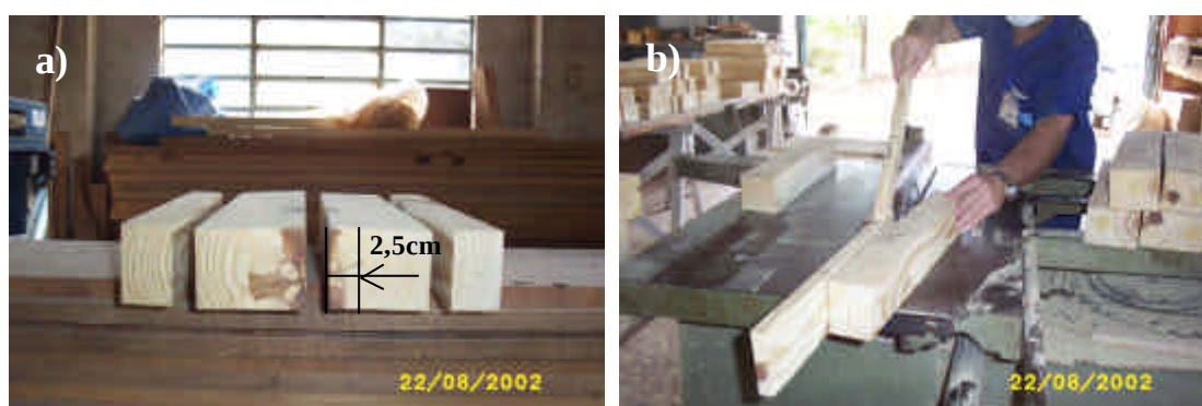
Figura 21 – Confecção dos corpos-de-prova longitudinais de madeira juvenil. a) marcação de 2,5cm a partir da medula; b) descarte da área medular.
