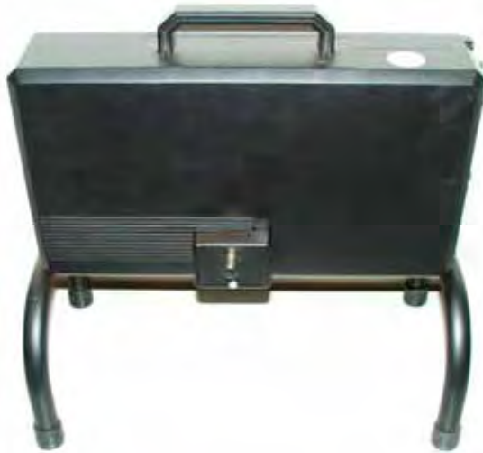
FIGURA 10. Vista geral do opacímetro TM 133 (Fonte: LOPES, 2006).
