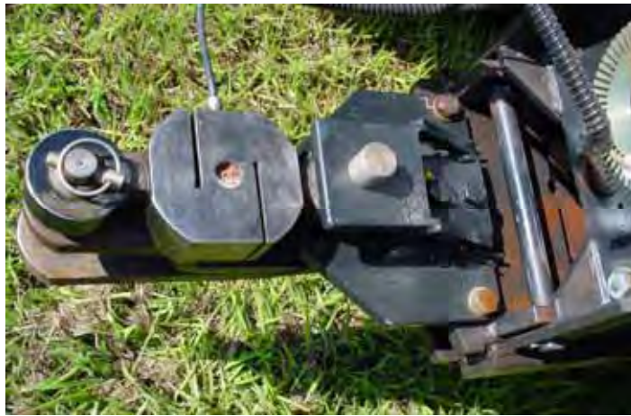
FIGURA 6. Célula de carga acoplada à barra de tração.
