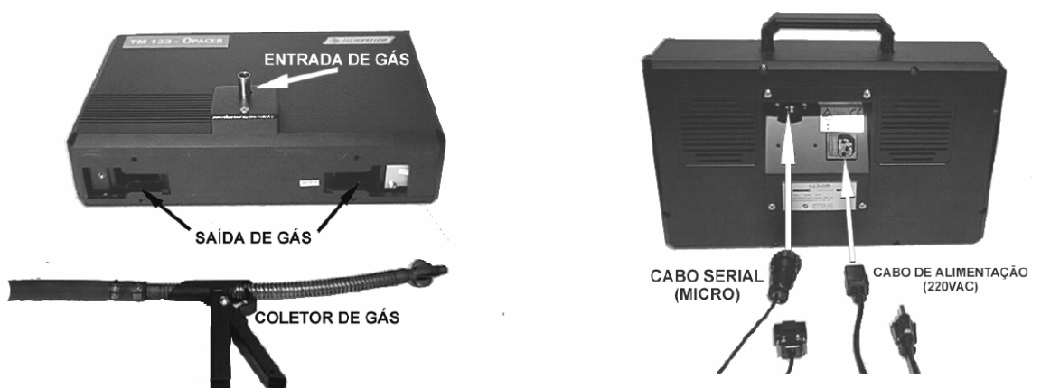
FIGURA 11. Vista detalhada do opacímetro (Fonte: TECNOMOTOR, 2006).
