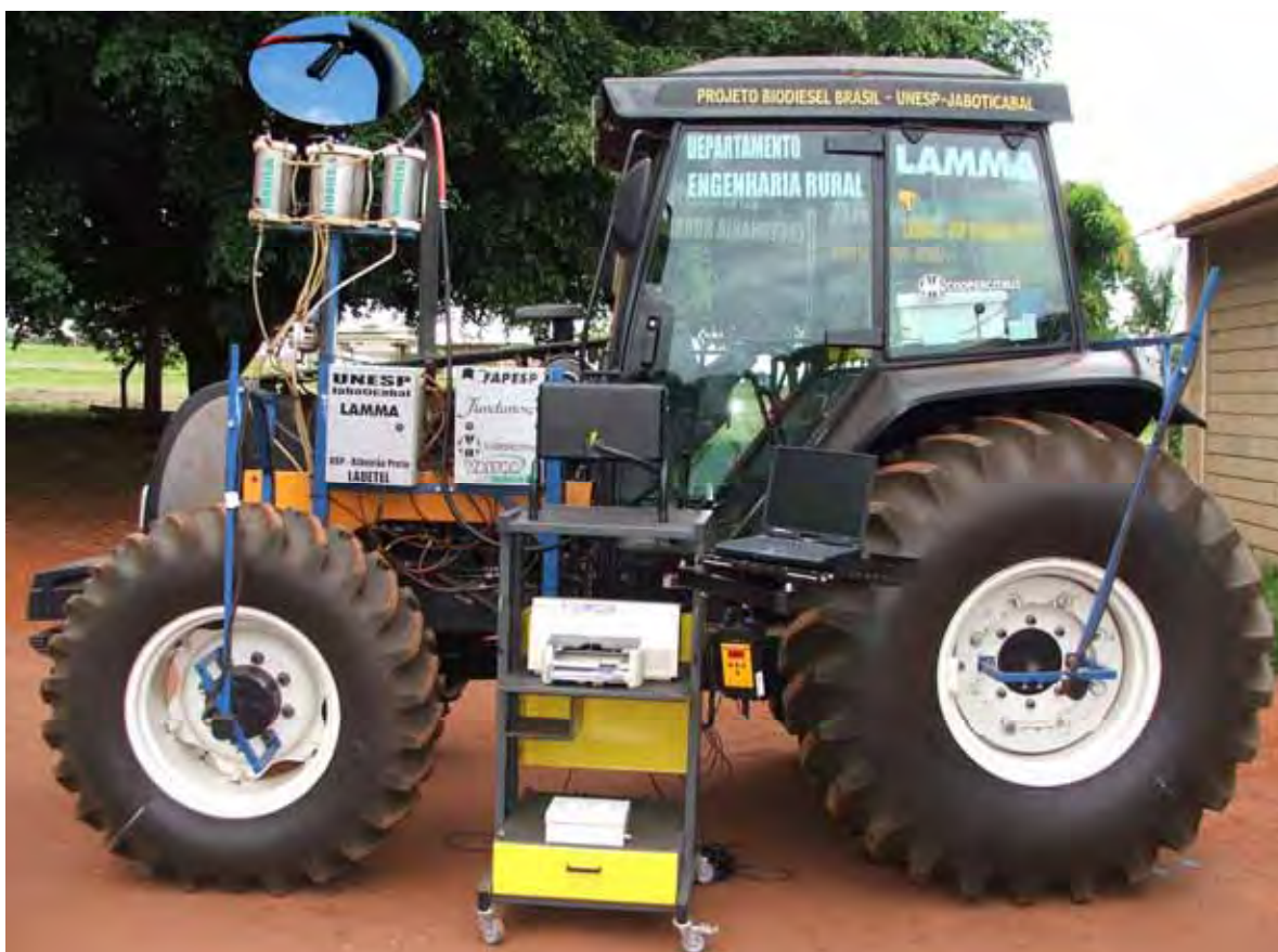
FIGURA 14. Vista geral do trator instrumentado para o ensaio de opacidade da fumaça (Fonte: LOPES, 2006).
