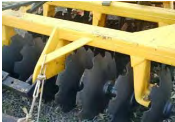
FIGURA 3. Vista da grade aradora de arraste.
