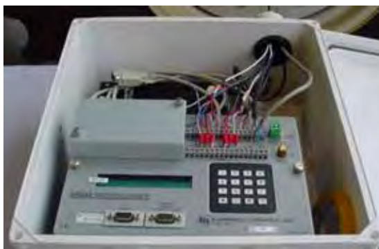
FIGURA 7. Sistema de aquisição de dados ligado aos sensores.
