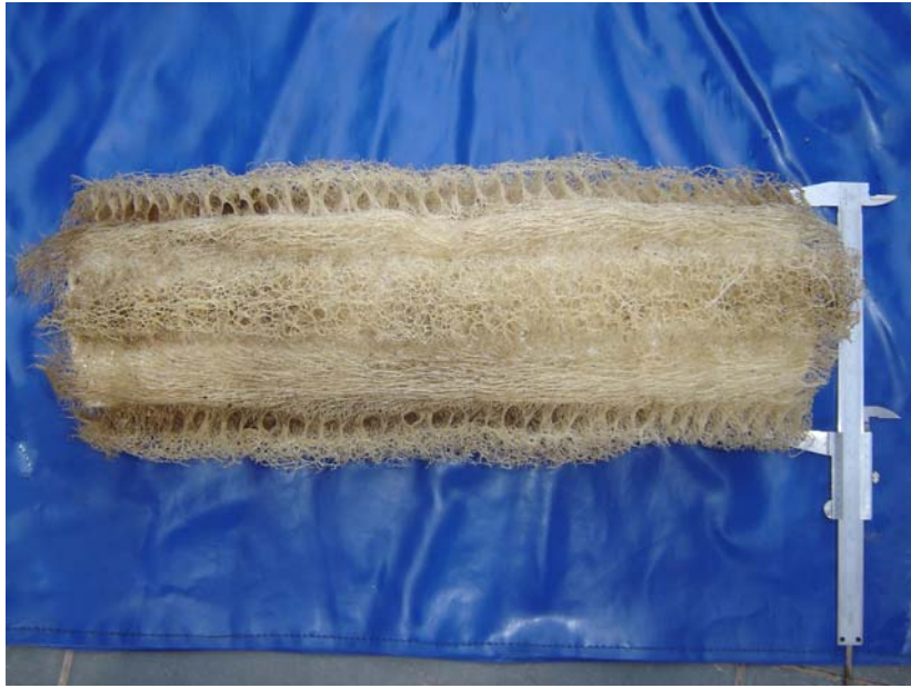
Figura 1: Foto de um coletor artificial passivo confeccionado com fibra vegetal (40cm de comprimento x 10cm de diâmetro).
