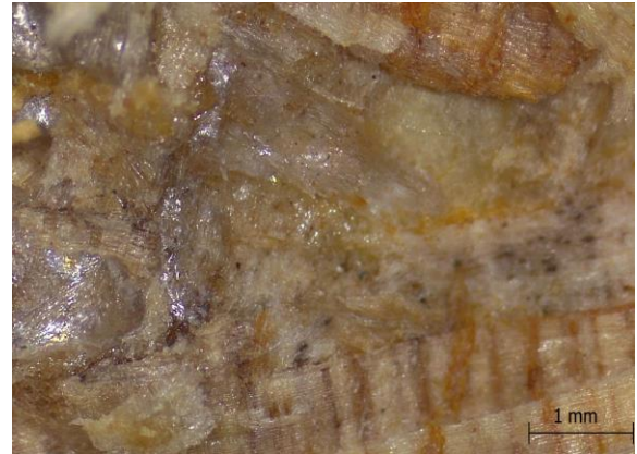
(b) Região de ruptura do cp do painel da mistura M70P 30PET 10
