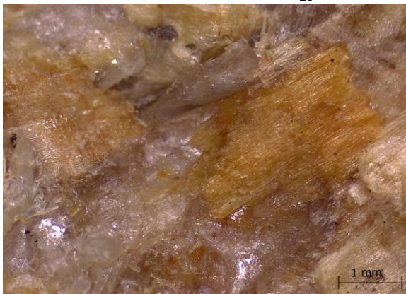
(c) Região de ruptura do cp do painel da mistura M50P 50PET 10
