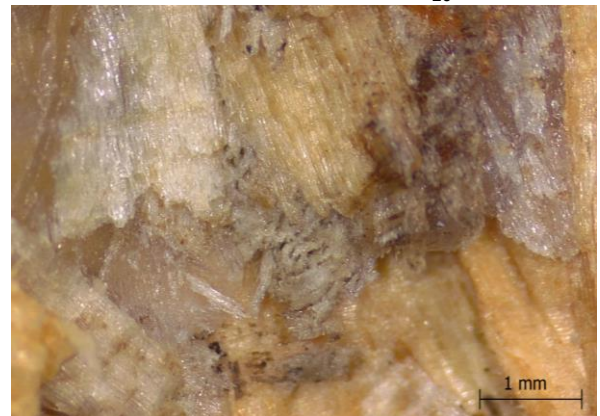
(d) Região de ruptura do cp do painel da mistura M70P 30PET 5
