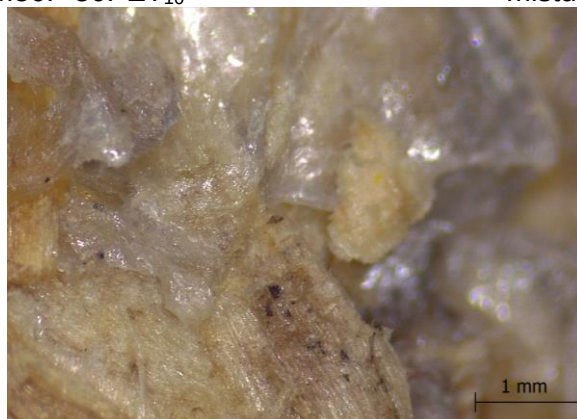
(e) Região de ruptura do cp do painel da mistura M50P 50PET 5
