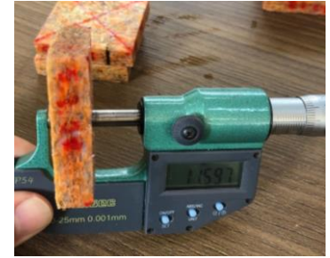
(c) Aferição de espessura final
