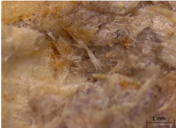
(a) Região de ruptura do cp do painel da mistura M100P 0PET 10
