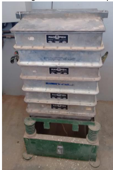
Figura 10 – Agitador elétrico de peneiras
