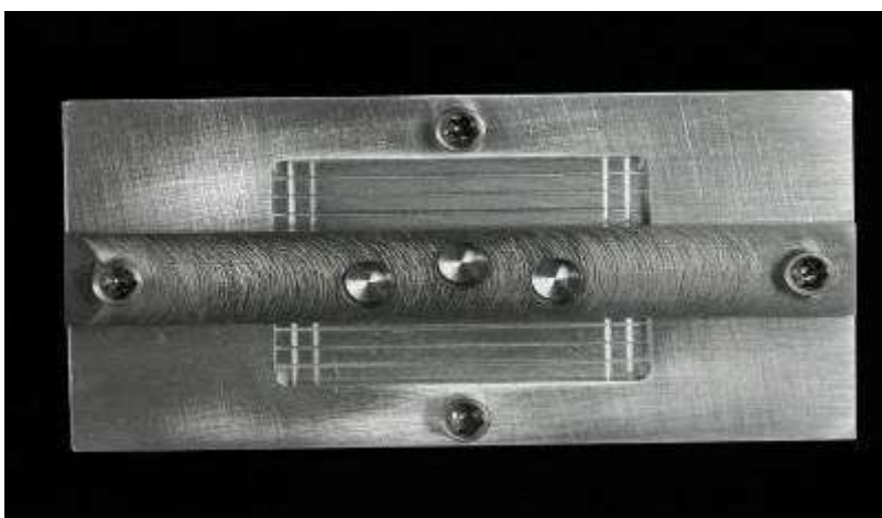
FIGURA 4 - matriz com a montagem dos três componentes na configuração compensada
