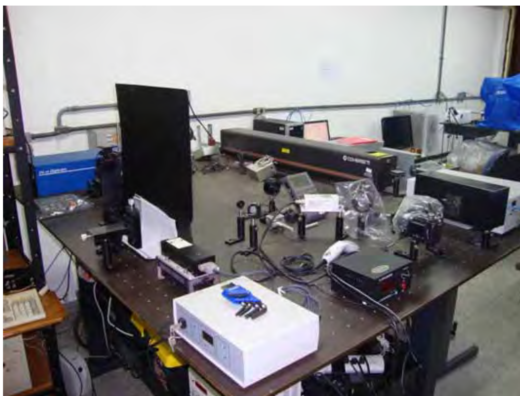
Figura 3.4. Sistema de medida de Fluorescência Induzida por Laser (LIFS) - Embrapa Instrumentação Agropecuária, São Carlos – SP.
