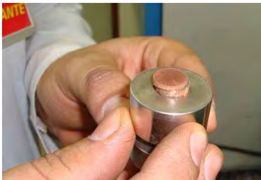
Figura 3.2. Pastilha de 10 mm de diâmetro e 2 mm de espessura utilizada nas análises de fluorescência induzida por laser (LIFS) e espectroscopia de emissão óptica com plasma induzido por laser (LIBS).
