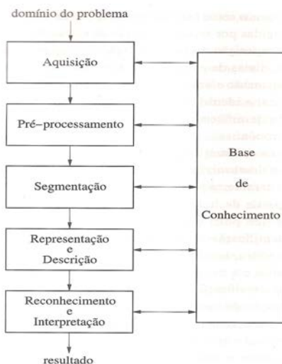
Figura 16: Etapas de um sistema de processamento de imagens. Fonte: Pedrini e Schwartz (2008)
