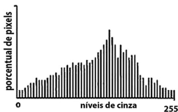
Figura 17: Histograma composto pelos 256 níveis de cinza e a porcentagem de pixels para cada nível contido na imagem.
