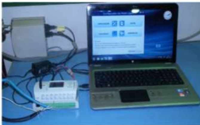
Figura 24 – Sistema de aquisição de dados SCADA
