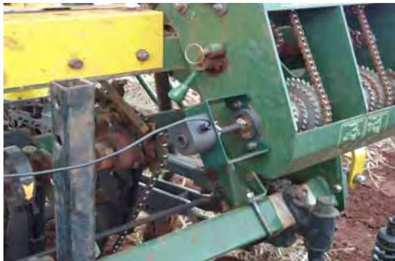
Figura 7. Relação de engrenagens e sensores instalados na semeadora-adubadora.
