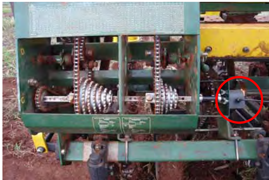
FIGURA 3. Sensor de rotação acoplado ao eixo das engrenagens da semeadora-adubadora.
