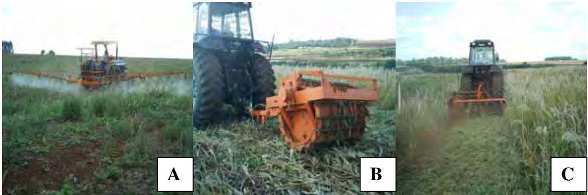
FIGURA 1. Trator Ford 6600 e pulverizador de barras tratorizado utilizado em operação de manejo (A); Trator BM 100 tracionando rolo-faca na operação de manejo do sorgo (B) e Trator BM 100 acoplado ao triturador de palhas no momento do manejo do sorgo (C).
