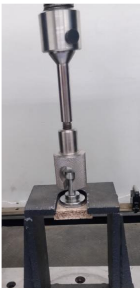
Figura 30 – Ensaio de resistência superficial.
