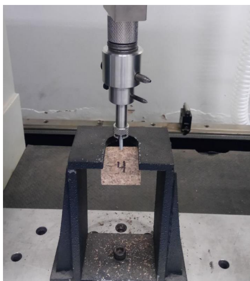
Figura 29 – Ensaio de arrancamento de parafuso.
