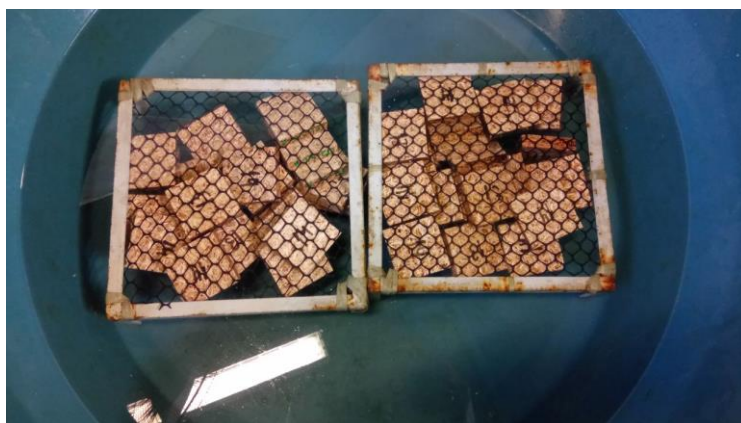
Figura 27 – Corpos de prova submersos em água.
