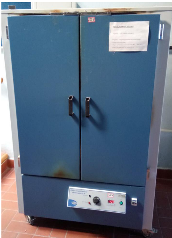
Figura 17 – Estufa com circulação e renovação de ar SOLAB.
