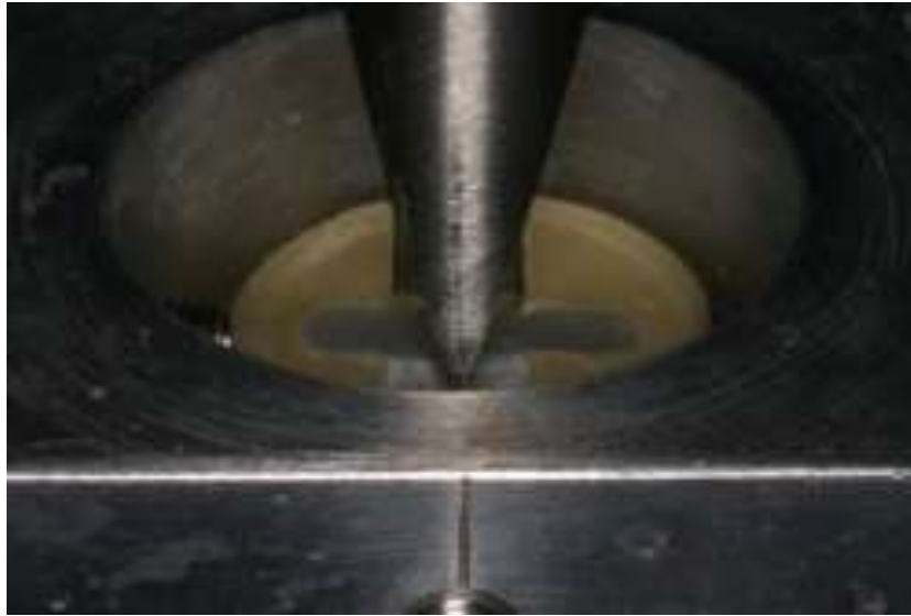
Figura 17–Teste de fratura – EMIC célula de carga de 50 Kgf.
