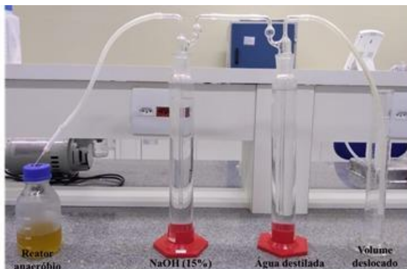
Figura 9 - Sistema de medição volumétrica para quantificação do biogás gerado
