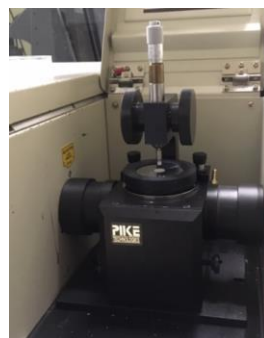
Figura 22 - Fotografia do espectrômetro JASCO FT/IR-410 com destaque para o dispositivo de análise pela técnica ATR.
