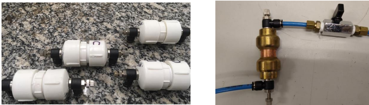
Figura 18 - Modelos de capsulas para acondicionamento das amostras de silicone tratadas em plasmas de \text{CHCl}_3 em atmosfera controlada de argônio. A esquerda as capsulas poliméricas montadas para as análises de XPS e a direita a capsula fabricada com conexões de engate rápido em liga de cobre.
