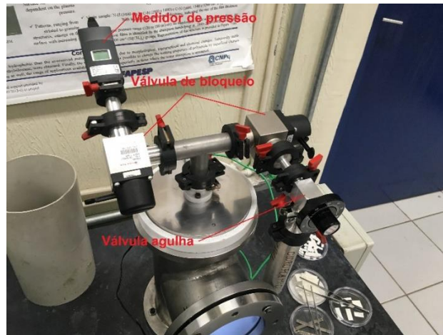
Figura 14 - Fotografia do medidor de pressão e da válvula agulha.
