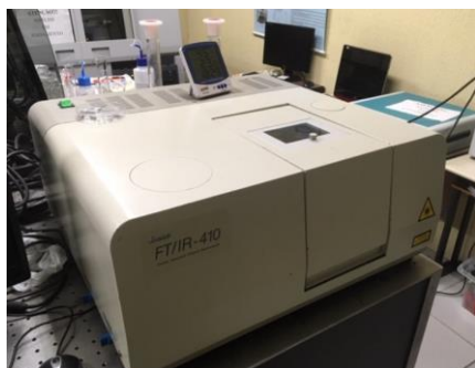
Figura 22 - Fotografia do espectrômetro JASCO FT/IR-410 com destaque para o dispositivo de análise pela técnica ATR.
