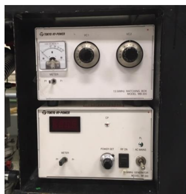
Figura 15 - Fotografia da fonte de radiofrequência Tokyo Hy-Power RF-300 e do casador de impedâncias MB 300.
