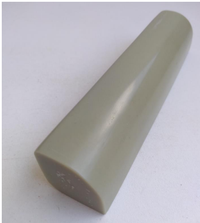
Figura 25 – Modelo 08 confeccionado em Resina Poliéster com carga.
