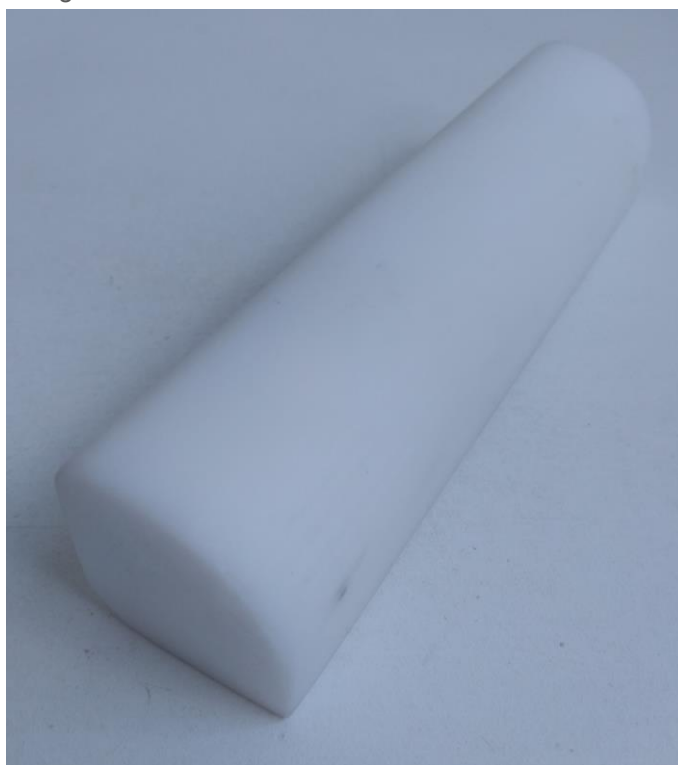
Figura 23 – Modelo 06 confeccionado em Poliacetal.
