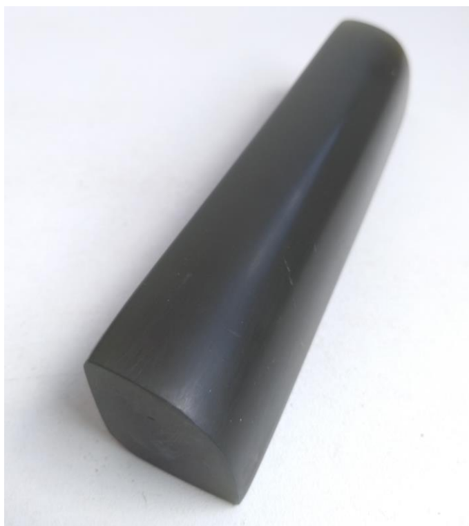
Figura 26 – Modelo 09 confeccionado em Resina Poliéster sem carga.
