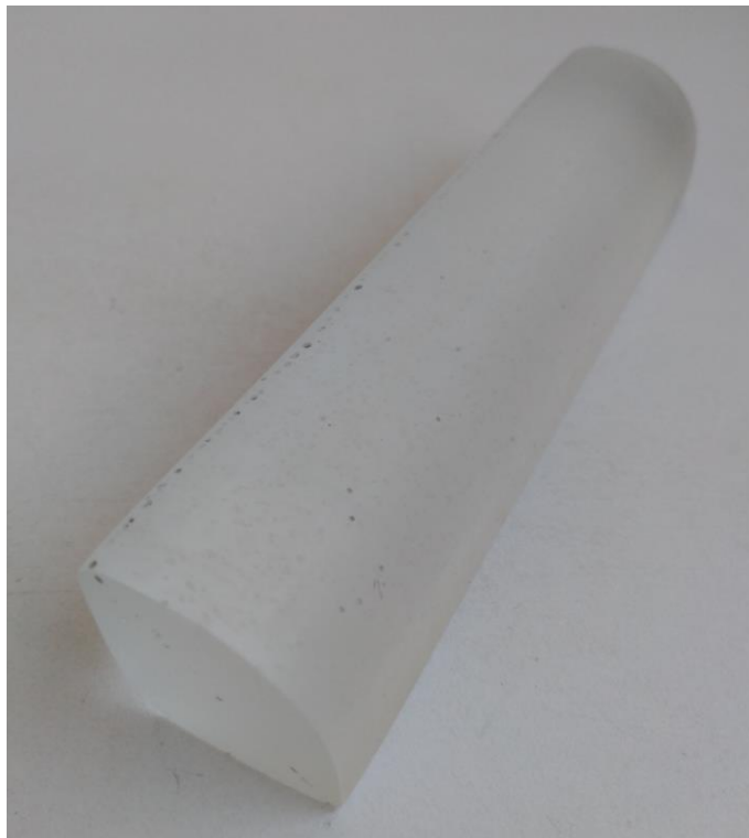
Figura 30 – Modelo 13 confeccionado em Resina de Poliuretano Cristal.
