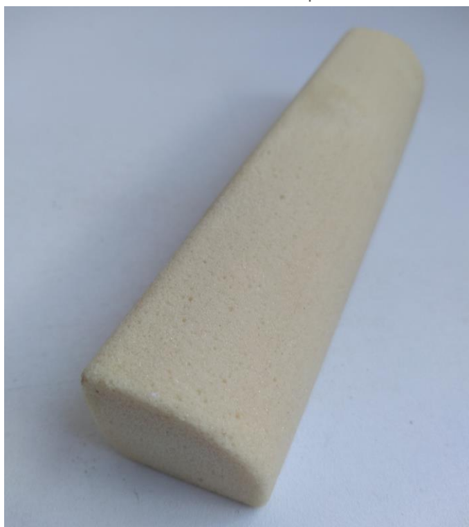
Figura 34 – Modelo 17 confeccionado em espuma de Poliuretano rígida.
