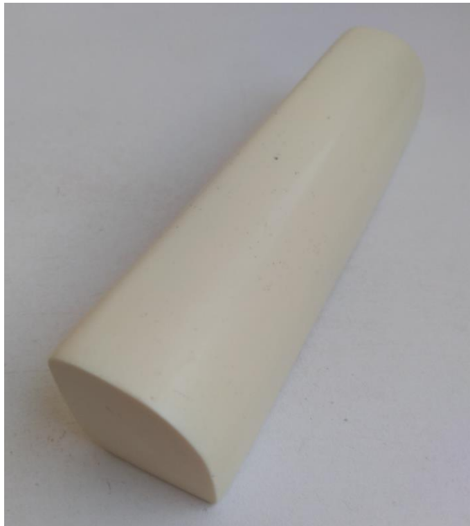
Figura 29 – Modelo 12 confeccionado em Resina de Poliuretano.
