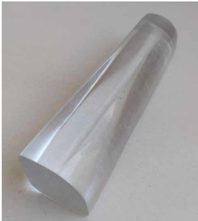
Figura 27 – Modelo 10 confeccionado em Resina Poliéster Cristal.
