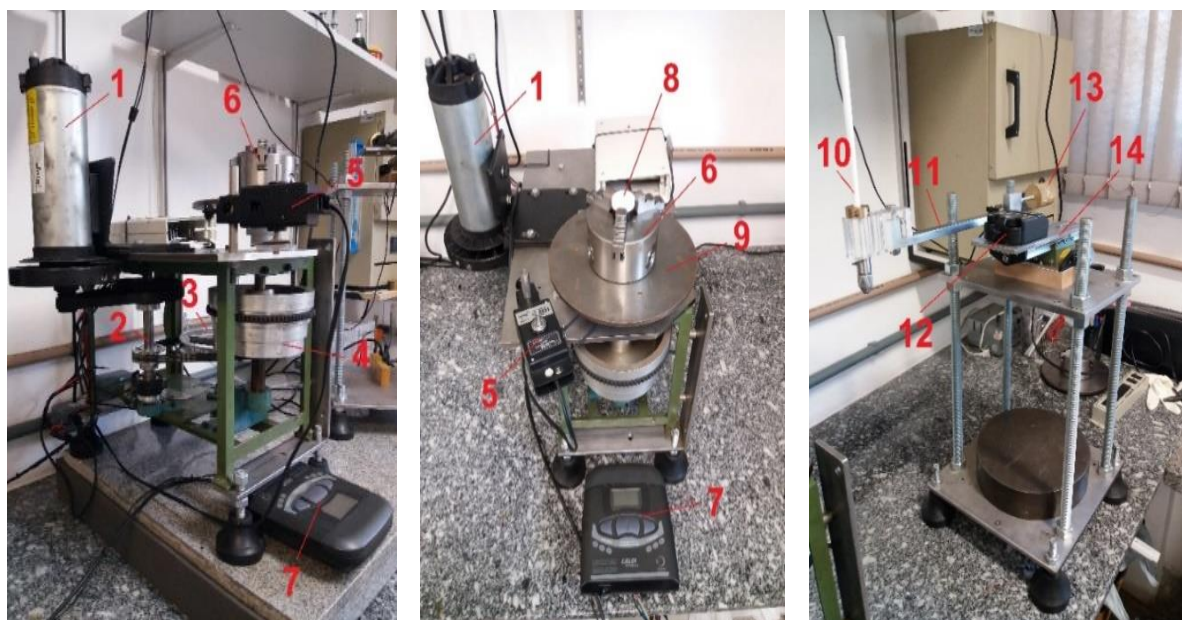
Figura 3.13: Tribômetro: (1) - motor elétrico; (2) - Eixo e transmissão após transmissão da rotação do motor elétrico; (3) - Eixo intermediário da transmissão do movimento de rotação; (4) – Eixo de transmissão do movimento de rotação final; (5) - Sensor de movimento rotativo; (6) – Platô com garras; (7) - Controlador de velocidade angular; (8) - Amostra presa nas garras do platô e (9) - Placa cilíndrica presa ao eixo de rotação da amostra, (10) – Haste de polímero, PP; (11) – Haste primária; (12) – Sensor de força; (13) – Contrapeso; (14) – Mesa coordenada XY; (15) – Haste secundária.
