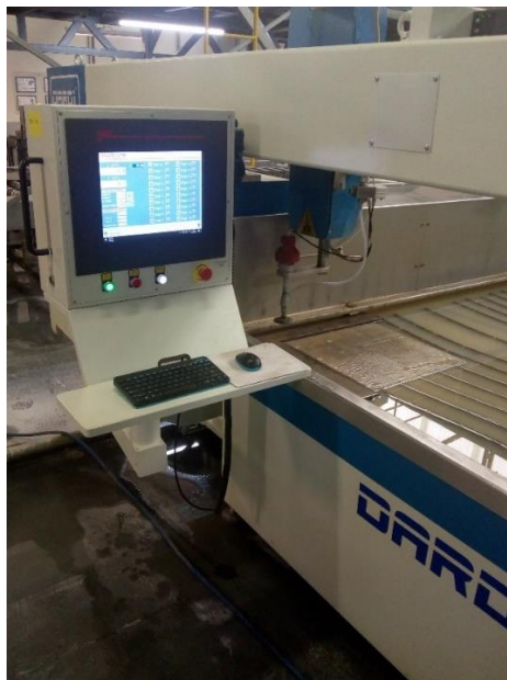
Figura 3.5: Máquina de corte com jato d'água modelo BB – GANTRY BRIDGE - DARDI.
