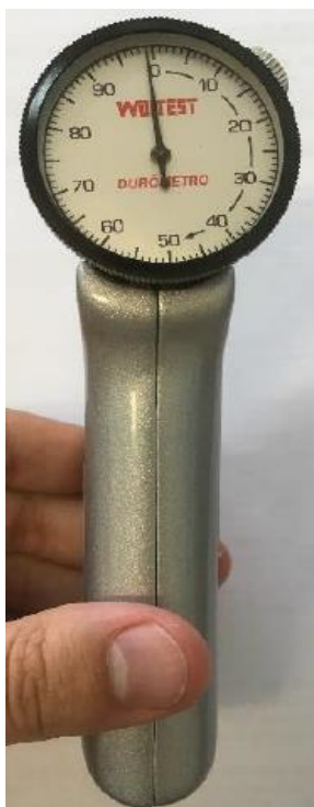
Figura 3.17: Durômetro Barcol, modelo GYZJ 934-1, Woltest.
