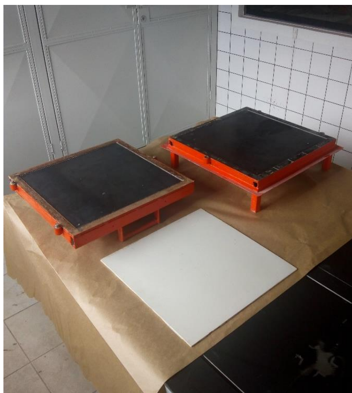
Figura 3.3: Molde metálico para a fabricação de amostras de corpos de prova Tipo III.
