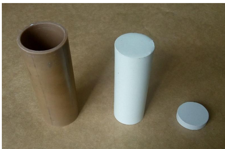
Figura 3.2: Corpo de prova Tipo II. Molde em PVC, tarugo e disco.
