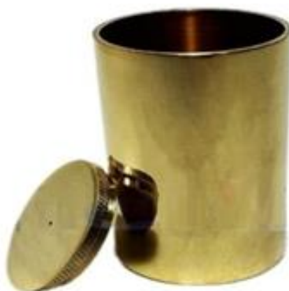
Figura 3.6: Picnômetro com tampa em latão polido – capacidade 50 ml.
