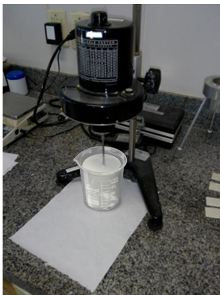
Figura 3.11: Viscosímetro rotacional modelo LVT.
