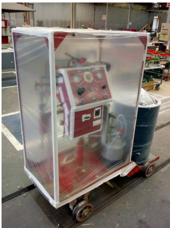
Figura 3.25: Equipamento de injeção para “RTM”, modelo Spartan II da Glas Craft.
