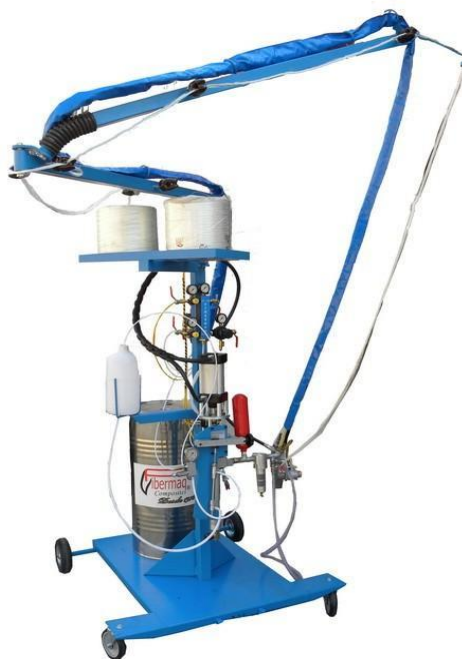
Figura 3.24: Máquina laminadora “ SPRAY-UP ”, modelo Glas Craft.
