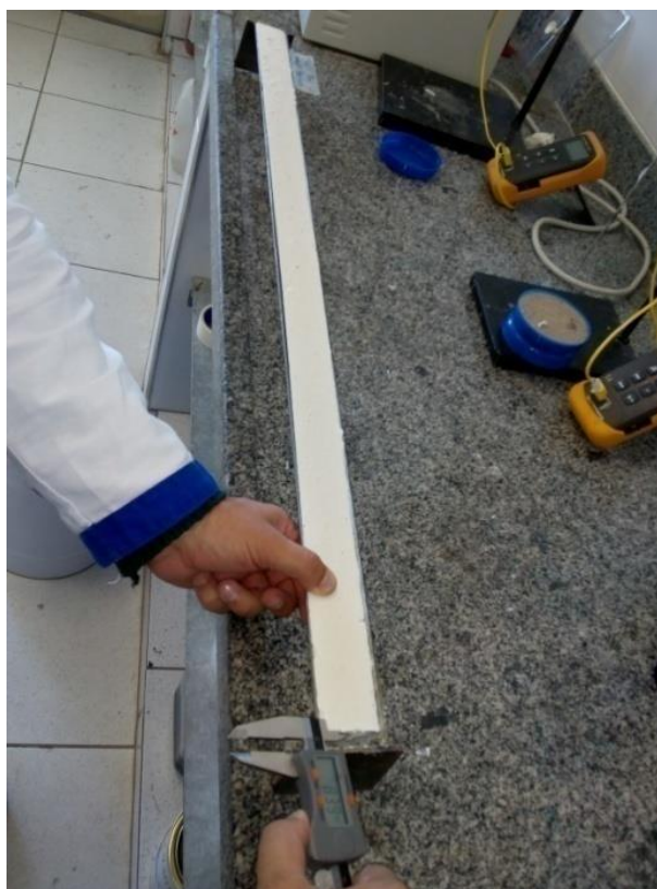
Figura 3.10: Medição da contração linear pós cura.
