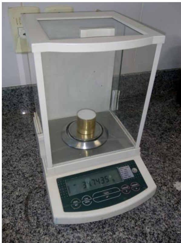
Figura 3.7: Balança analítica modelo AY 220 - SHIMADZU.
