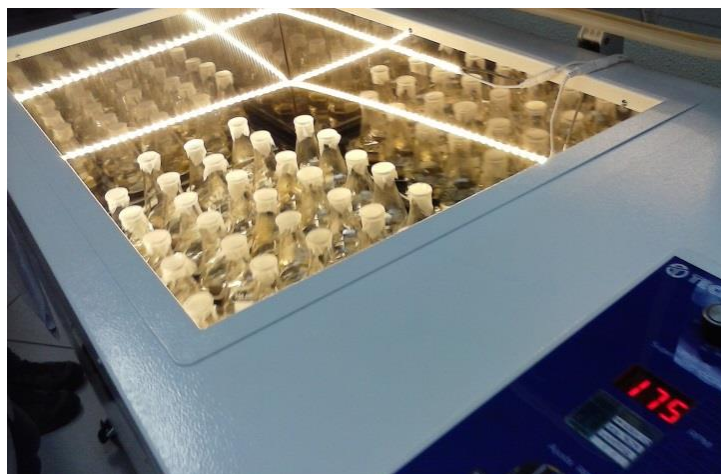
Figura 5 – Ensaio de Toxicidade com R. subcapitata em incubadora com agitação e luminosidade.
