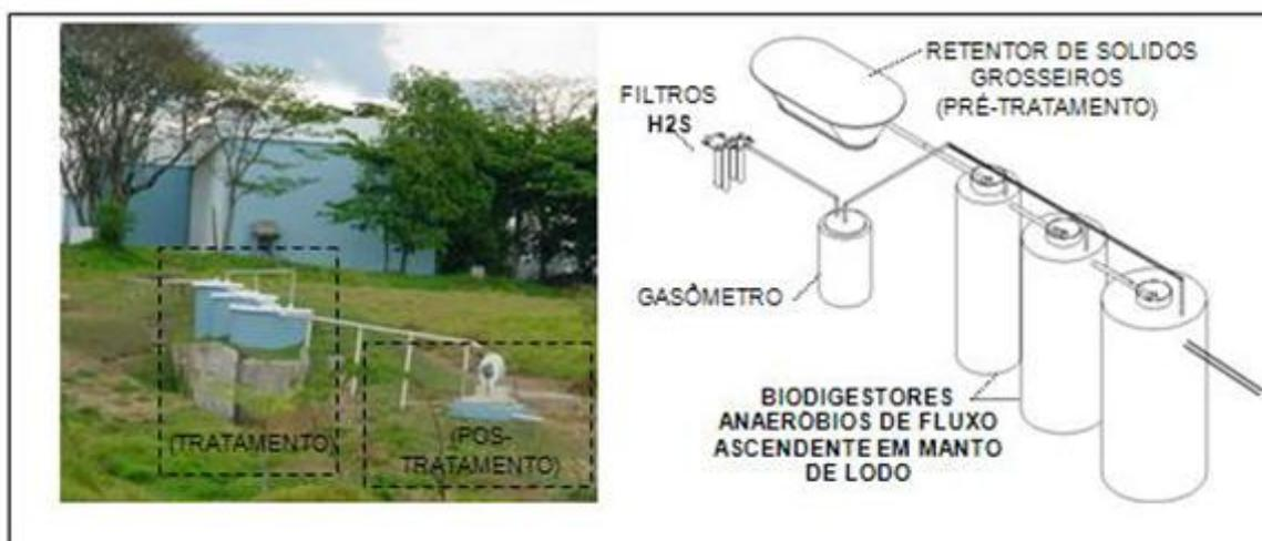
Figura 3 – Foto e desenho esquemático em 3D da miniEETERA.
