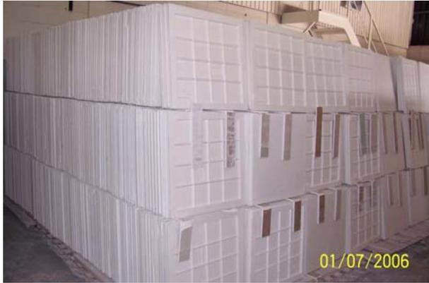
**Figura 12:** Placas de gesso para execução de forros.
