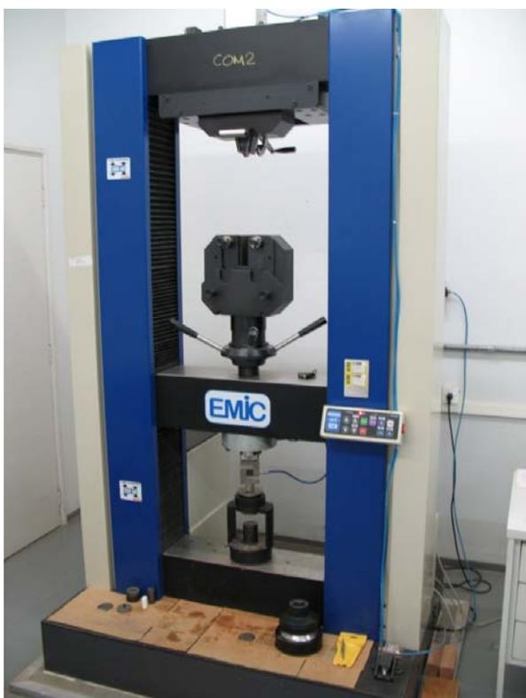
**Figura 34:** Máquina universal de ensaio utilizada.
