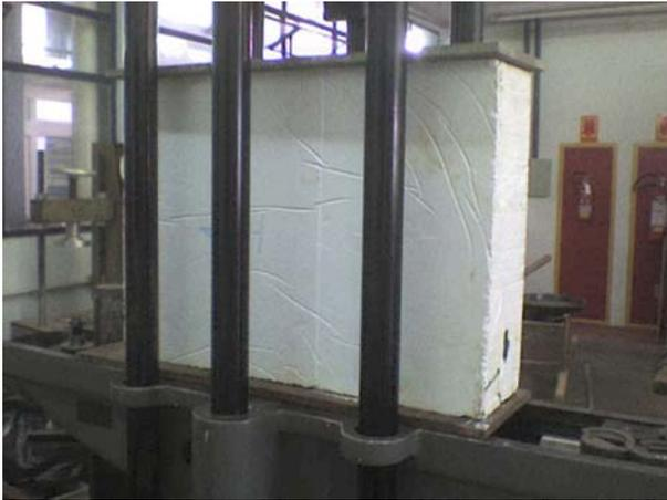
**Figura 68:** Bloco de gesso posicionado para o ensaio de compressão axial.
