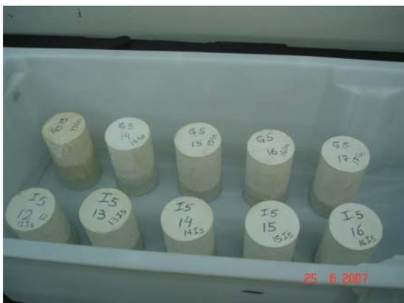
**Figura 27:** Corpos-de-prova com  $\frac{1}{3}$  do seu volume imerso.
