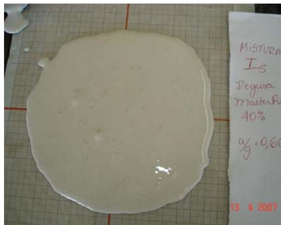
**Figura 23:** Ensaio de *mini-slump* com a pasta I<sub>5</sub>, de fluidez elevada.
