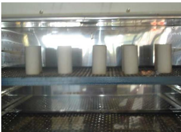
**Figura 25:** Amostras em estufa para secagem.
