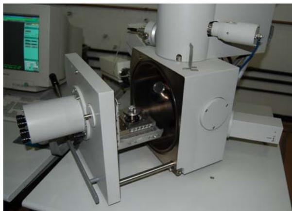
**Figura 37:** Colocação das amostras para análise da MEV.
