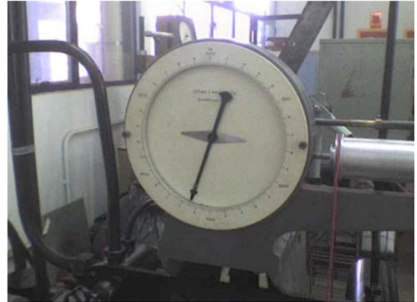
**Figura 69:** Mostrador do índice de carga da máquina universal de ensaio.
