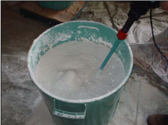
**Figura 43:** Fase de mistura dos componentes da pasta de gesso estudada.
