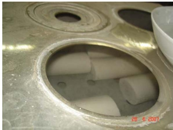
**Figura 30:** Detalhe dos corpos-de-prova após término do período de ebulição.
