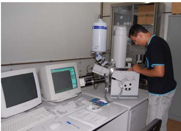
**Figura 36:** Microscópio eletrônico de varredura utilizado.
