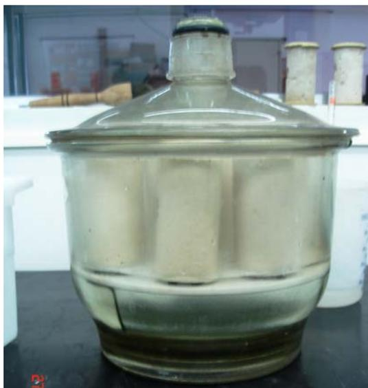
**Figura 33:** Corpos-de-prova sobre a lâmina d'água.
