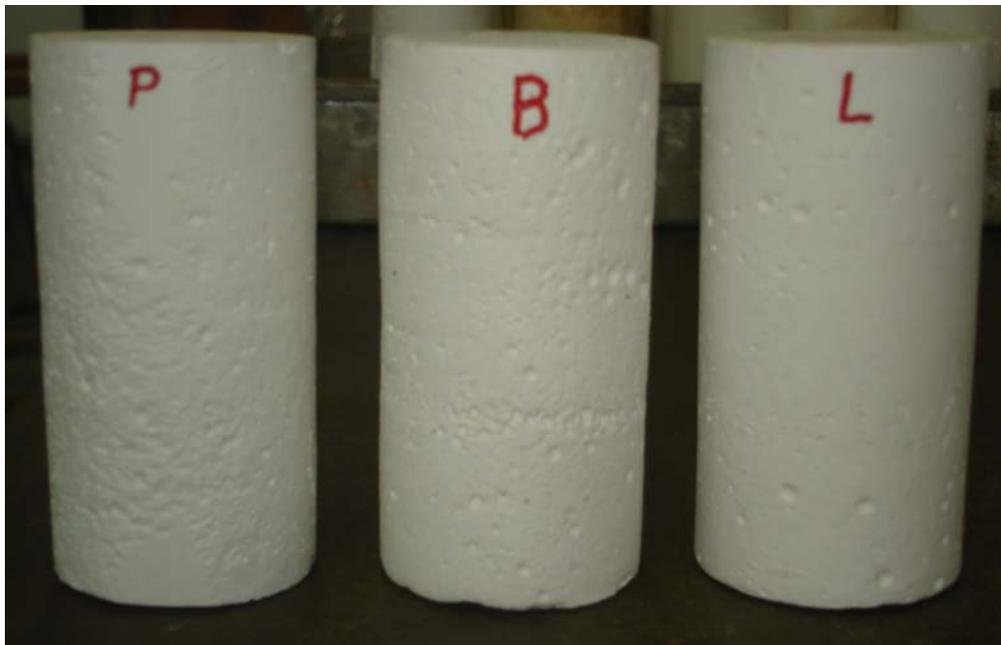
**Figura 46:** Aspecto da superfície dos corpos-de-prova traços P, B e L, após fervura.
