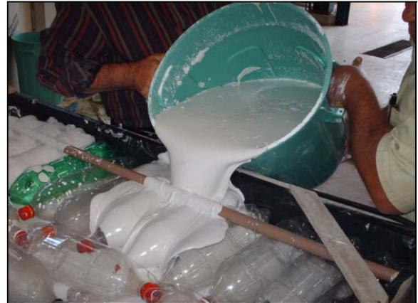
**Figura 44:** Vazamento da pasta de gesso na forma.
