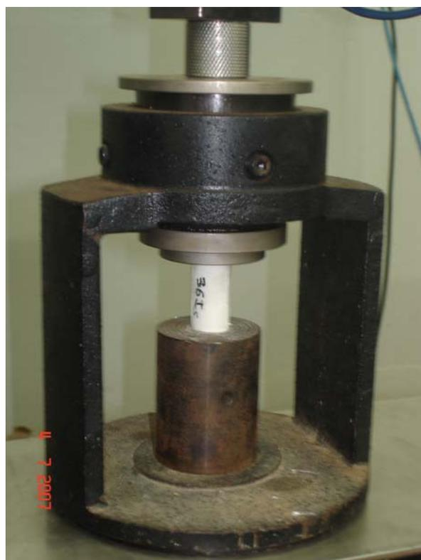
**Figura 35:** Detalhe da máquina de ensaios, com uma amostra sendo comprimida.
