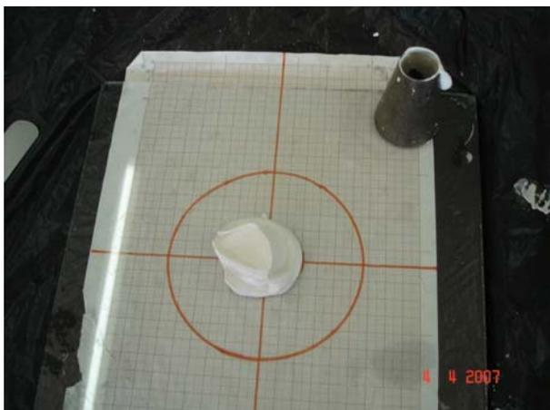
**Figura 22:** Ensaio de *mini-slump* com a pasta H<sub>5</sub>, de baixa fluidez.
