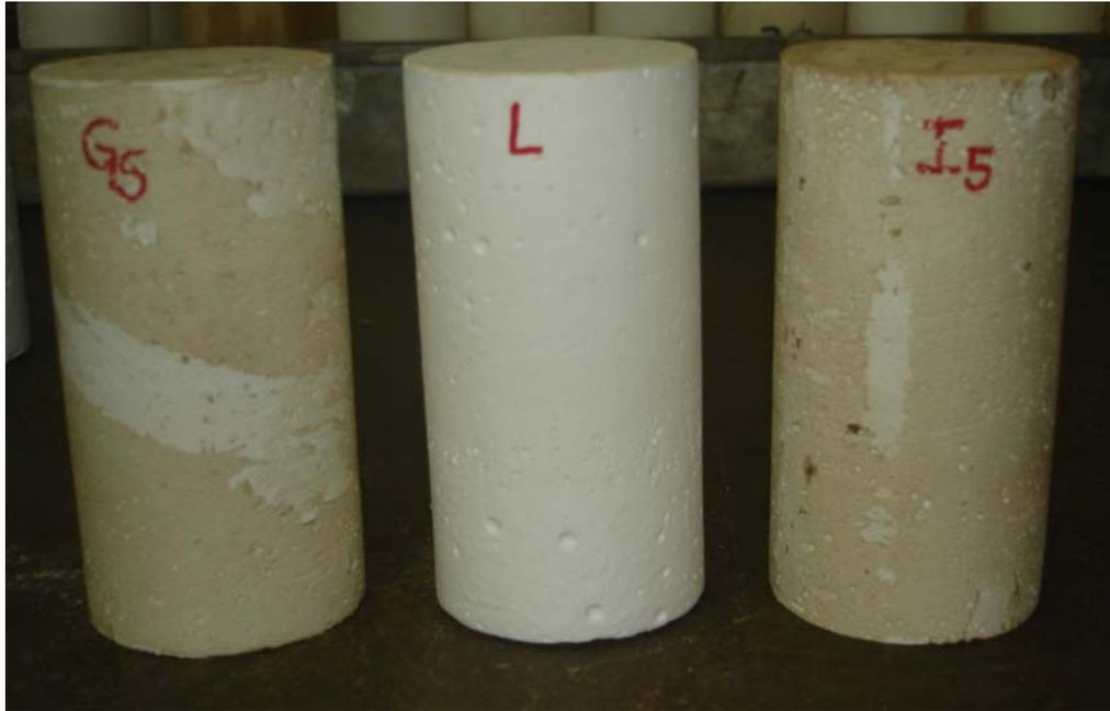
**Figura 45:** Aspecto da superfície das amostras sem aditivo (grupo L) e aditivadas (grupos G<sub>5</sub> e I<sub>5</sub>), após fervura.
