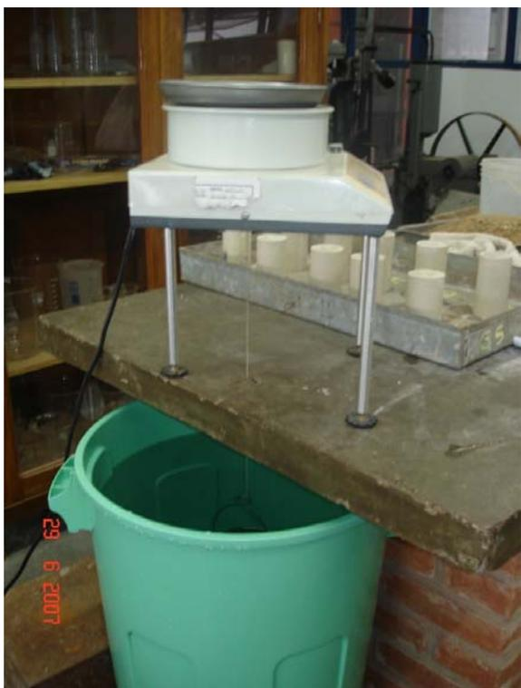
**Figura 31:** Conjunto da balança para pesagem hidrostática.
