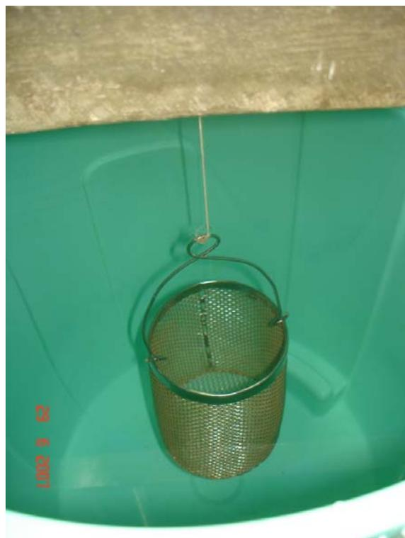
**Figura 32:** Cesto para amostras, no conjunto da balança.
