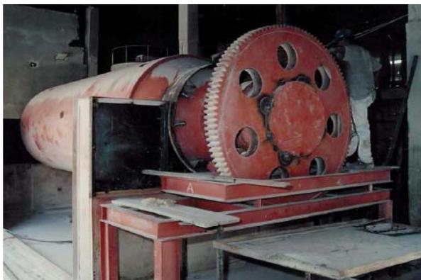
**Figura 8:** Forno de marmita horizontal utilizado na fabricação do gesso beta.
