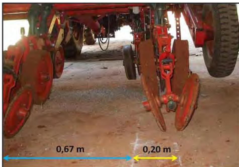
**Figura 1.** Ilustração da adaptação da sementeira para o espaçamento em linha dupla (0,20 m x 0,67 m).
