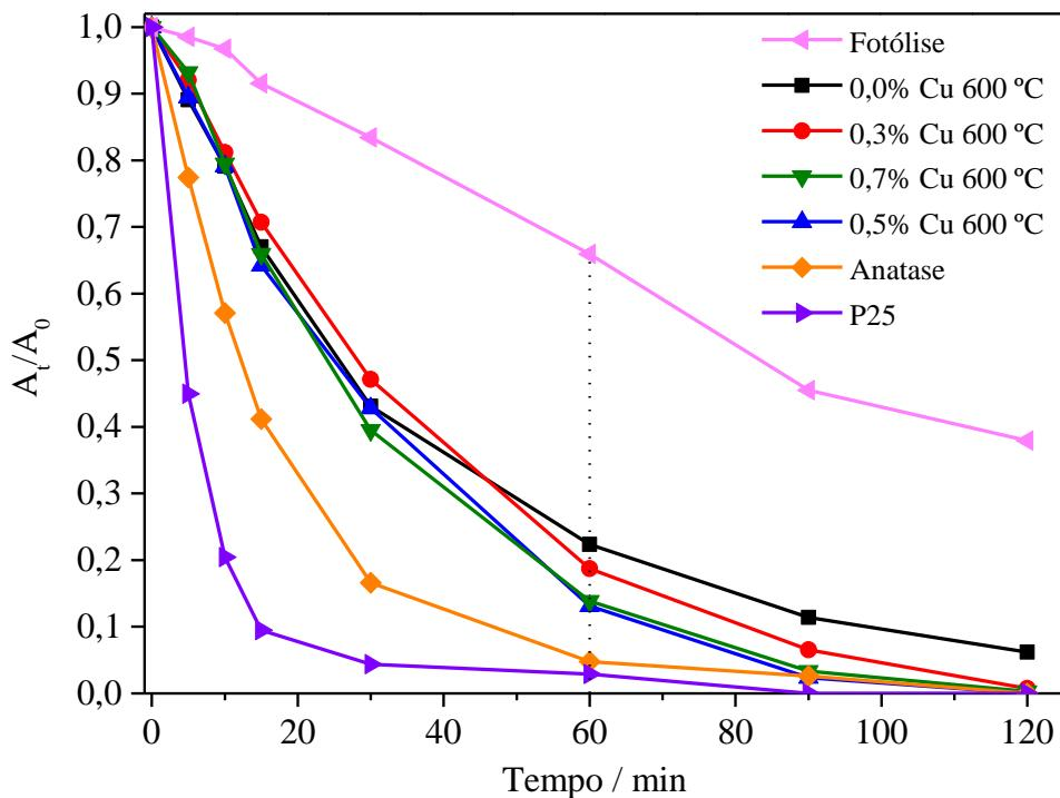
**Figura 34** – Curvas de eficiência photocatalítica dos materiais de  $\text{TiO}_2$  tratados termicamente à 600 °C.
