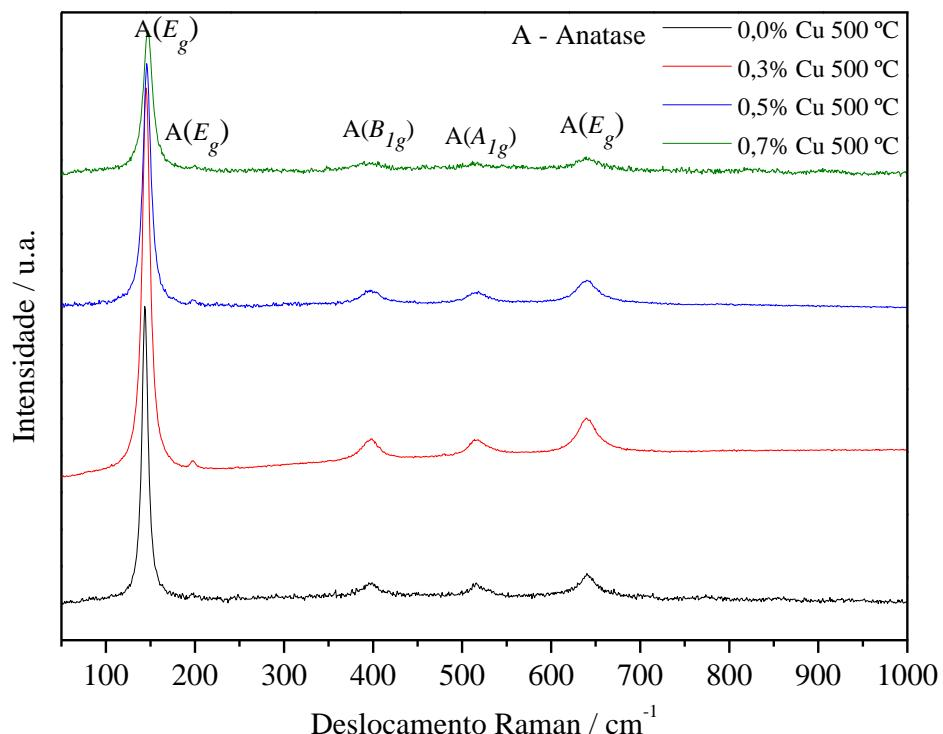
**Figura 14** – Espectros Raman das amostras de  $\text{TiO}_2$  tratadas à  $500\text{ }^{\circ}\text{C}$ .
