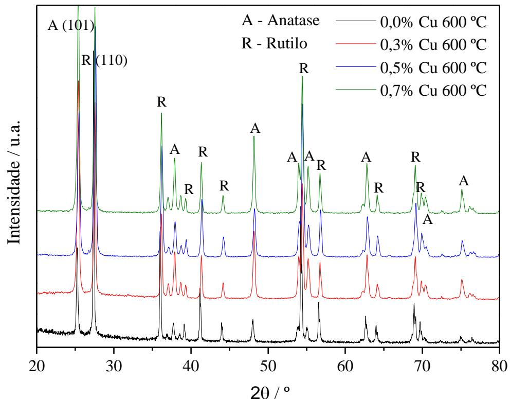
**Figura 12** – Padrões de difração de Raios X das amostras de TiO<sub>2</sub> com 0,0% e 0,3% Cu à 600 °C.
