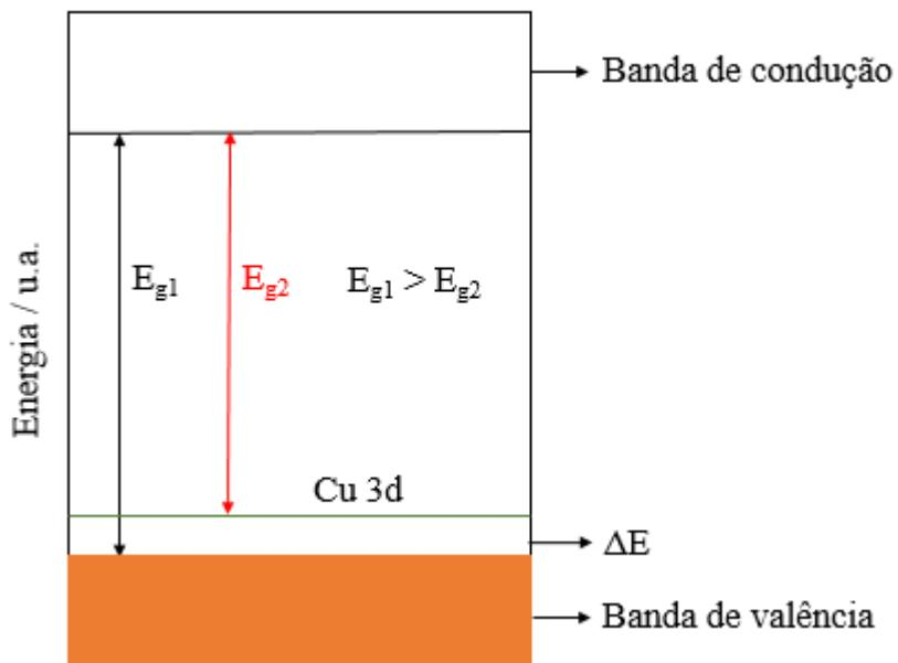
**Figura 19** – Modelo para estrutura de bandas do TiO<sub>2</sub> dopado com Cu.
