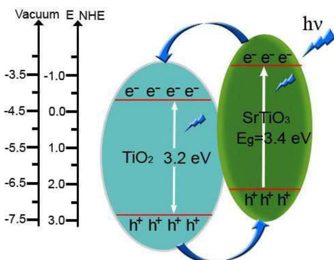
**Figura 4 – Heteroestrutura de  $\text{SrTiO}_3$  e  $\text{TiO}_2$  para aplicação photocatalítica.**
