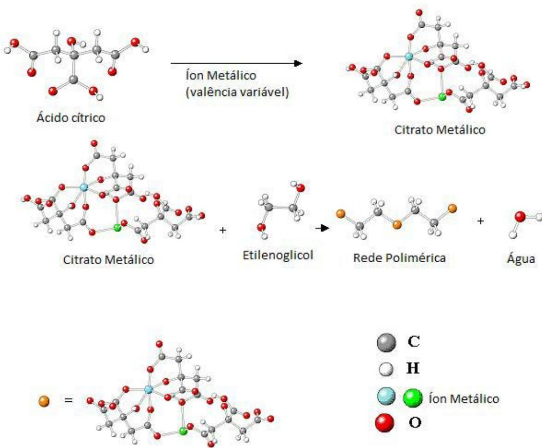
**Figura 7 – Mecanismo de formação da resina polimérica do metal.**
