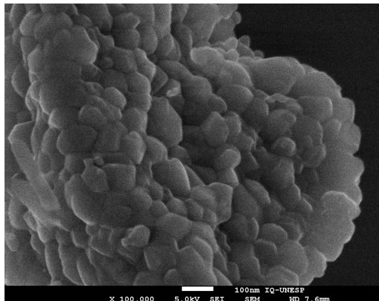
**Figura 24** – Micrografia obtida por FEG-SEM do  $\text{TiO}_2$  0,0% Cu tratado à 700 °C.
