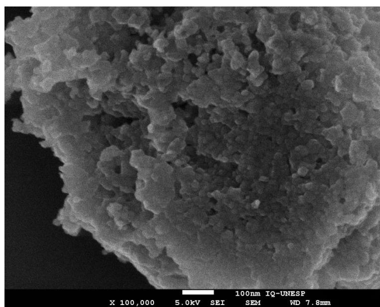
**Figura 20** – Micrografia obtida por FEG-SEM do  $\text{TiO}_2$  0,0% Cu tratado à 500 °C.
