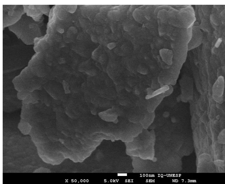
**Figura 25** – Micrografia obtida por FEG-SEM do  $\text{TiO}_2$  0,7% Cu tratado à 700 °C.
