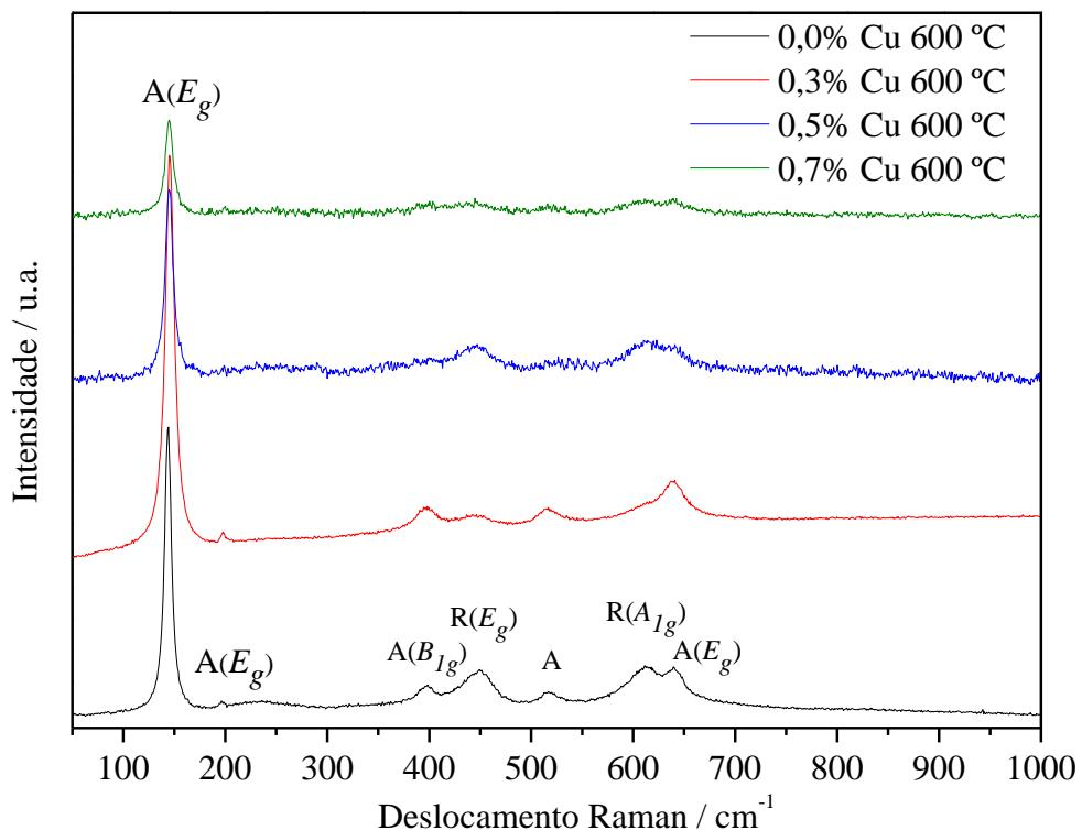
**Figura 15** – Espectros Raman das amostras tratadas à 600 °C.
