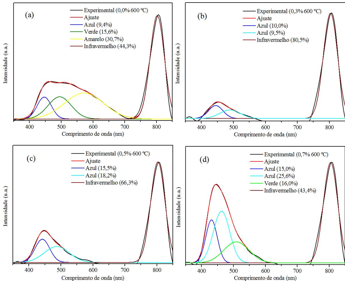
**Figura 28** – Deconvolução dos espectros fotoluminescentes das amostras tratadas à 600 °C com (a) 0,0% Cu, (b) 0,3% Cu, (c) 0,5% Cu e (d) 0,7% Cu.
