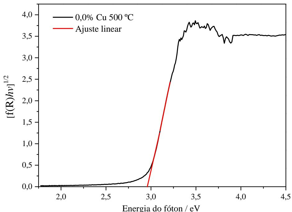
**Figura 17** – Espectro de UV-Vis da amostra TiO<sub>2</sub> 0,0% Cu à 500 °C.
