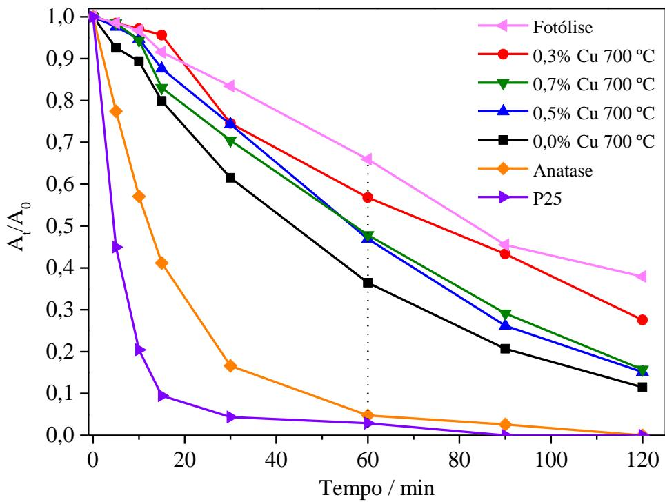
**Figura 35** – Curvas de eficiência photocatalítica dos materiais de  $\text{TiO}_2$  tratados termicamente à 700 °C.
