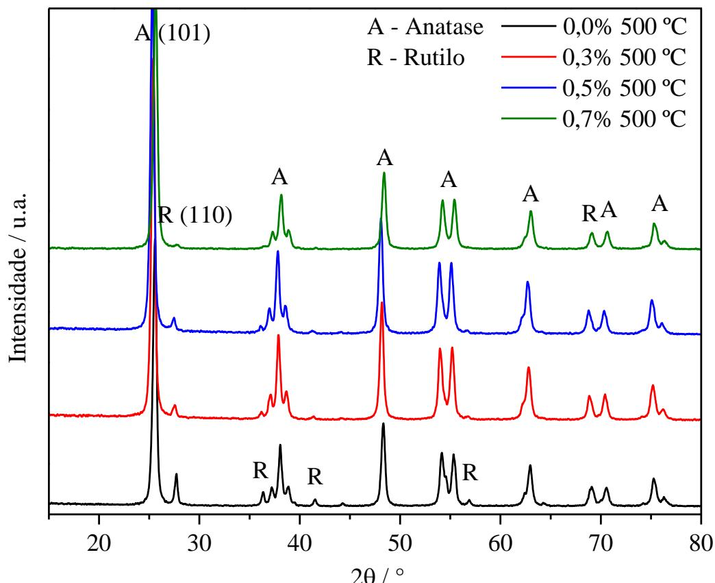
**Figura 11 – Padrões de difração de Raios X das amostras de  $\text{TiO}_2$  tratadas à 500 °C.**
