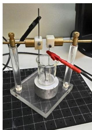
**Figura 10** – Célula eletroquímica de deposição.
