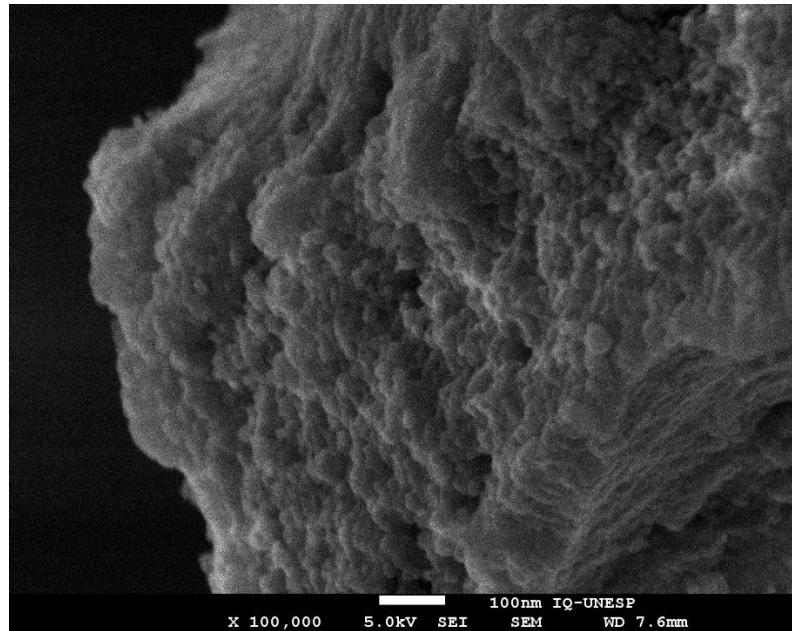
**Figura 21** – Micrografia obtida por FEG-SEM do TiO<sub>2</sub> 0,7% Cu tratado à 500 °C.
