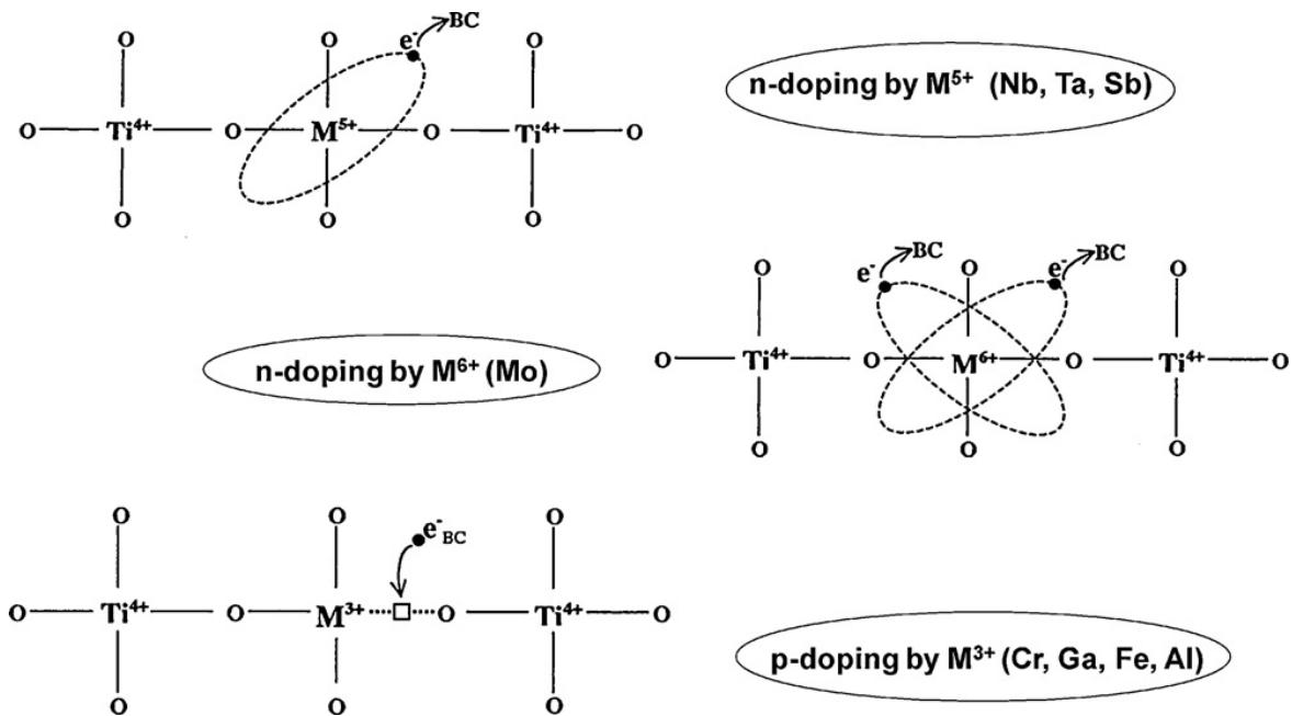
**Figura 5** – Esquema representativo das dopagens tipo n e p no  $\text{TiO}_2$ .
