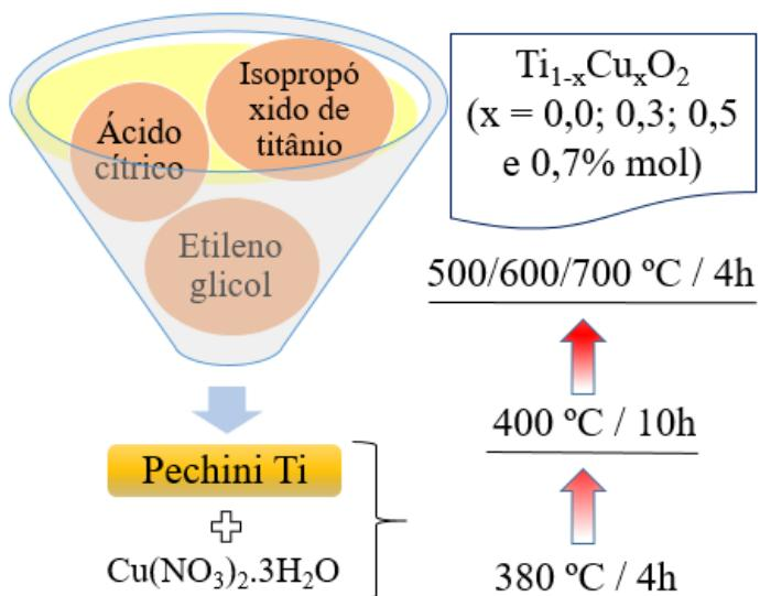
**Figura 8 – Fluxograma de síntese dos materiais.**
