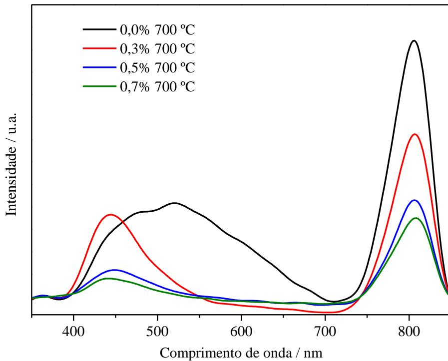
**Figura 31** – Espectros fotoluminescentes das amostras de  $\text{TiO}_2$  tratadas termicamente à  $700\text{ }^{\circ}\text{C}$ .
