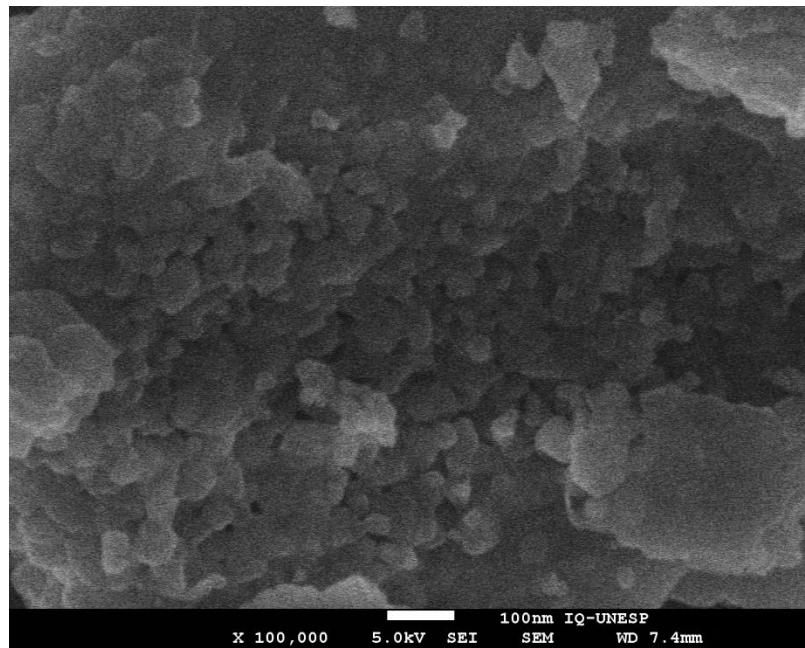
**Figura 23** – Micrografia obtida por FEG-SEM do  $\text{TiO}_2$  0,7% Cu tratado à 600 °C.
