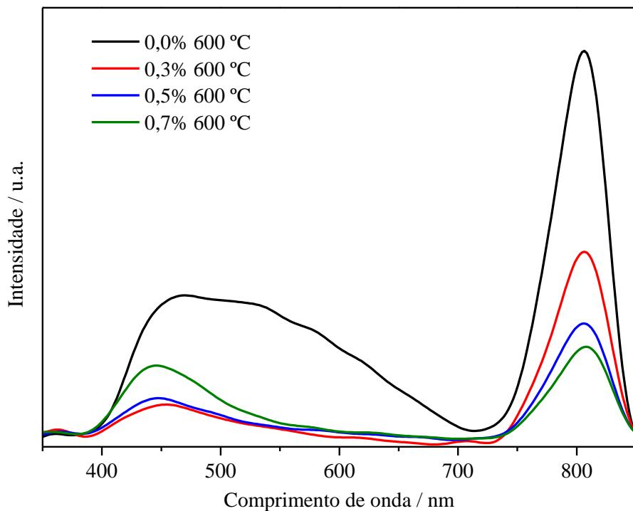
**Figura 29** – Espectros fotoluminescentes das amostras de TiO<sub>2</sub> tratadas termicamente à 600 °C.
