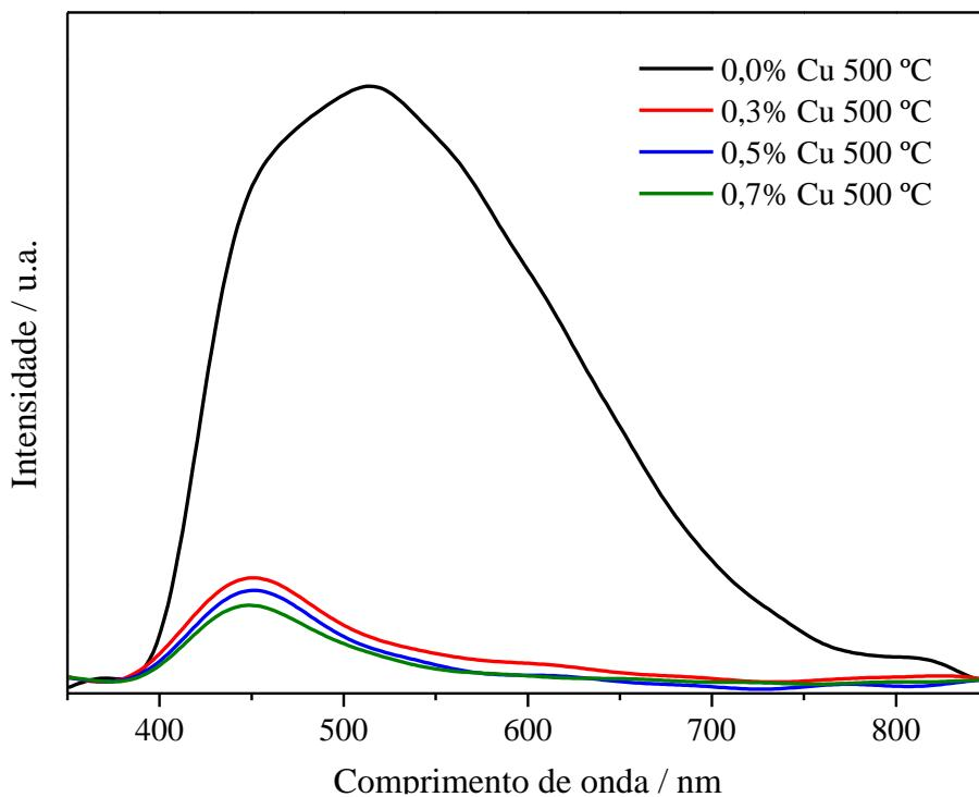
**Figura 27** – Espectros fotoluminescentes das amostras de  $\text{TiO}_2$  tratadas termicamente à 500 °C.
