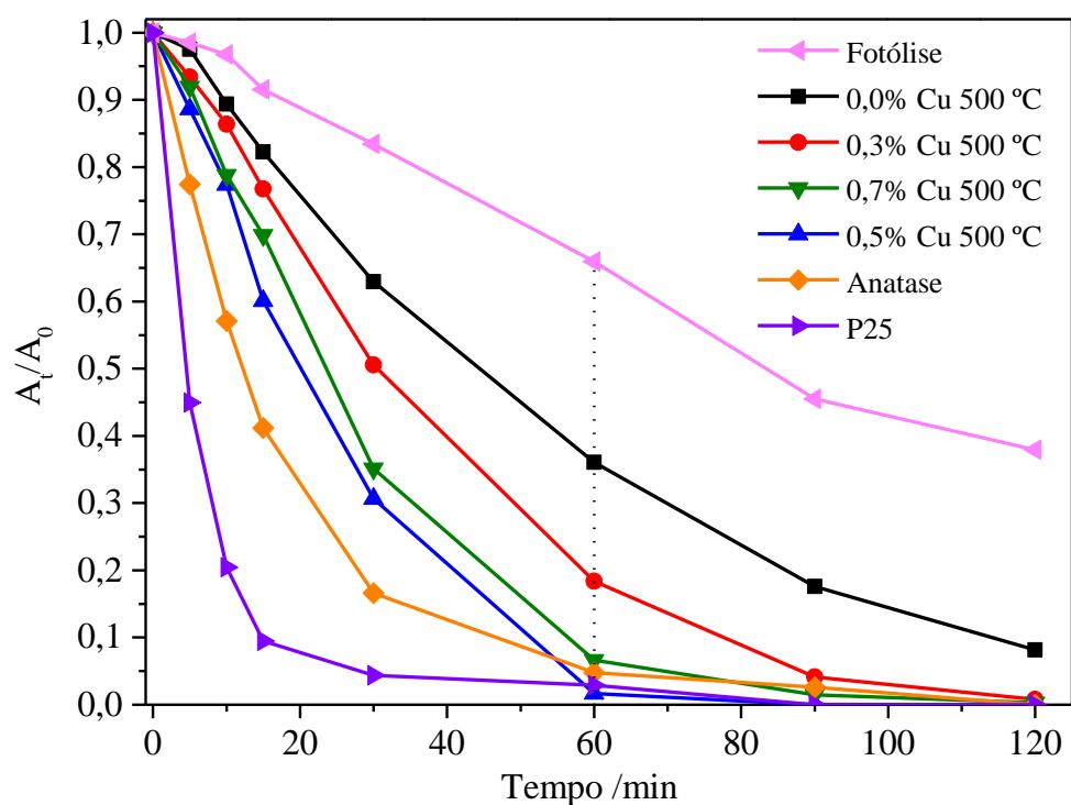
**Figura 32** – Curvas de eficiência photocatalítica dos materiais de TiO<sub>2</sub> tratados termicamente à 500 °C.
