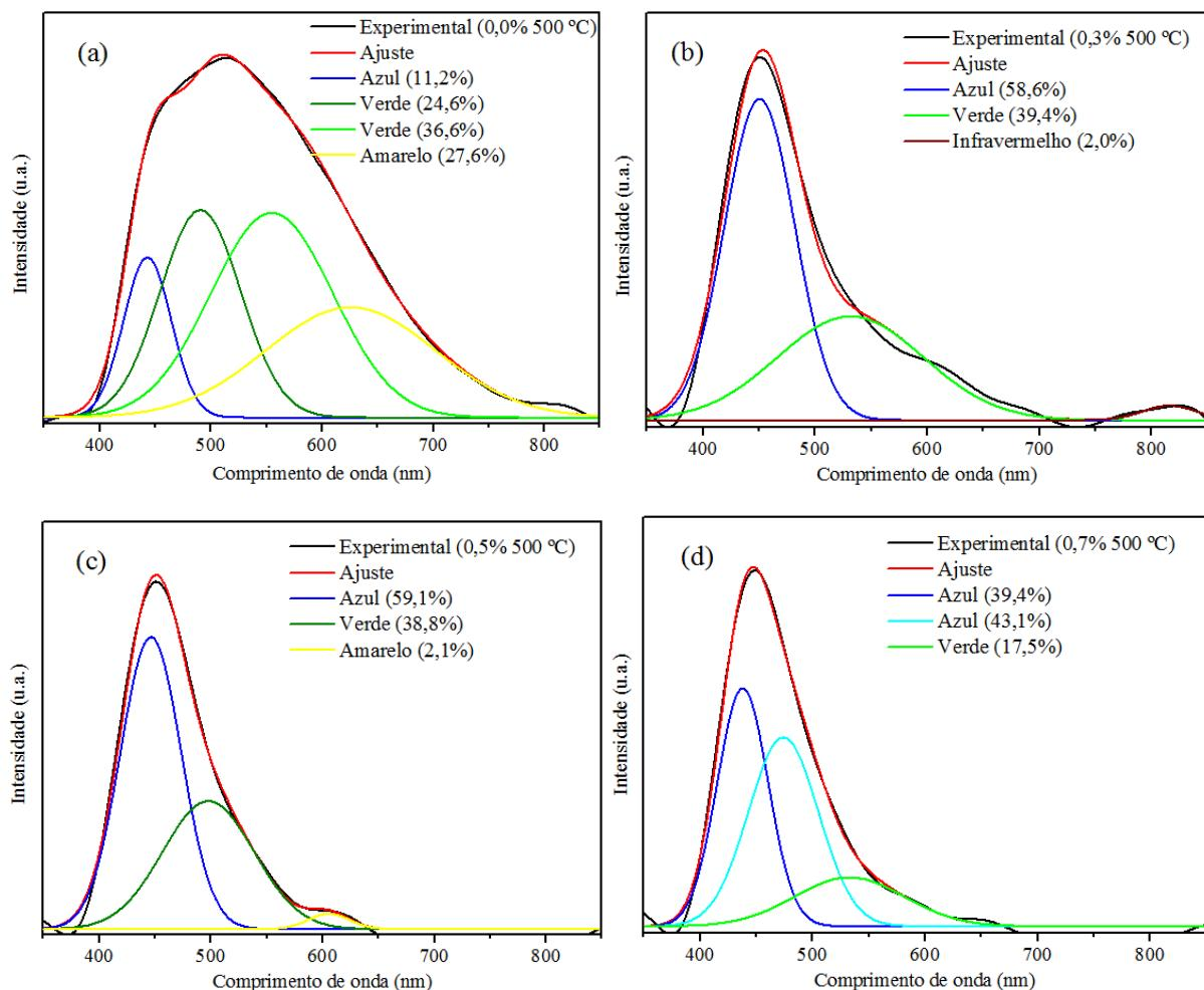
**Figura 26** – Deconvolução dos espectros fotoluminescentes das amostras tratadas à 500 °C com (a) 0,0% Cu, (b) 0,3% Cu, (c) 0,5% Cu e (d) 0,7% Cu.
