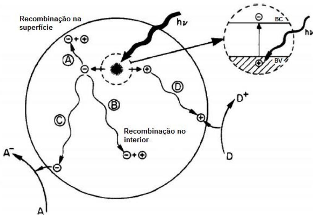
**Figura 1** – Representação dos mecanismos de geração do par elétron/buraco e de sua ação geral no processo photocatalítico.
