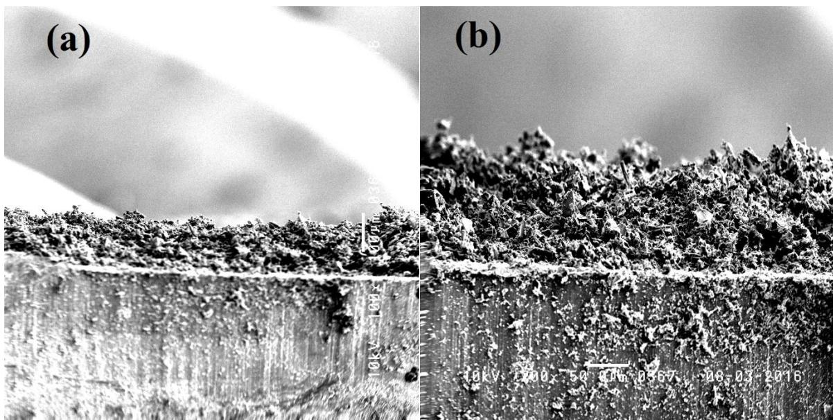
**Figura 36** – Micrografias obtidas por SEM do filme de  $\text{TiO}_2$  0,5% Cu tratado à 500 °C com magnificação (a) 100x e (b) 200x.
