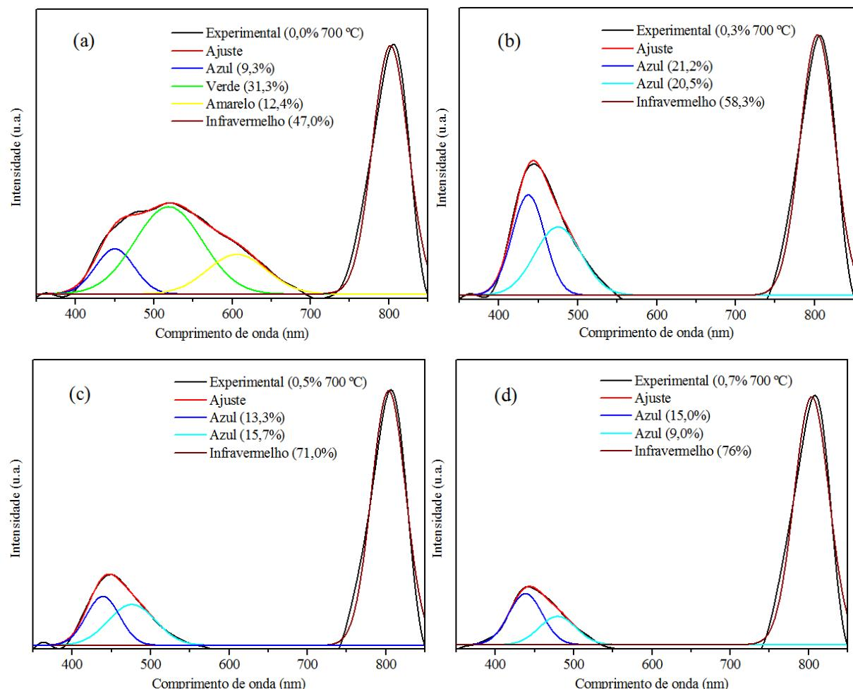
**Figura 30 – Deconvolução dos espectros fotoluminescentes das amostras tratadas à 700 °C com (a) 0,0% Cu, (b) 0,3% Cu, (c) 0,5% Cu e (d) 0,7% Cu.**
