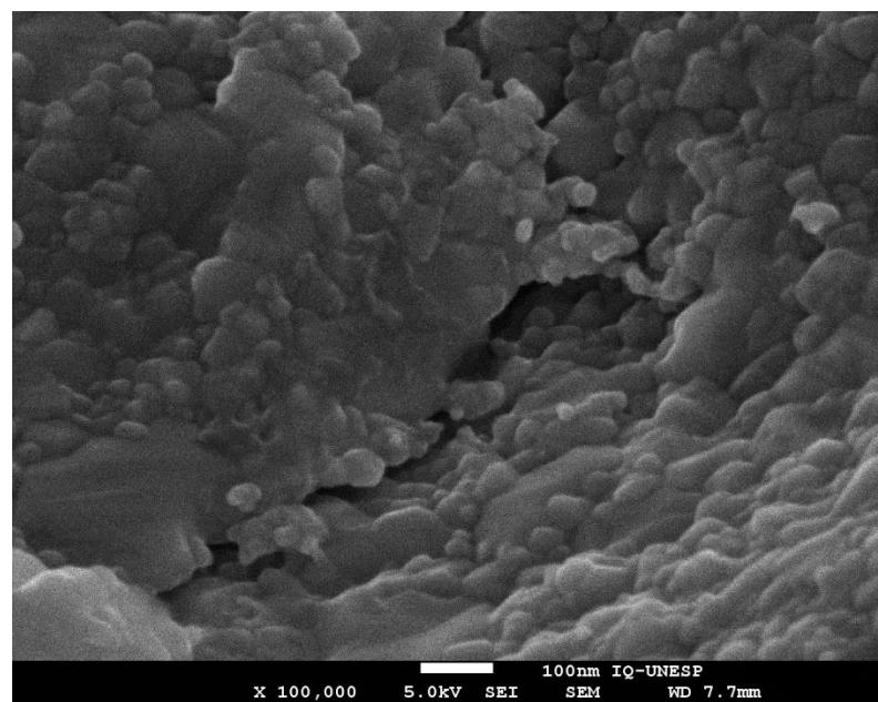
**Figura 22** – Micrografia obtida por FEG-SEM do TiO<sub>2</sub> 0,0% Cu tratado à 600 °C.
