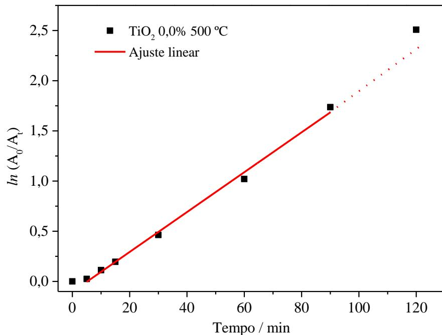
**Figura 33 – Linearização da curva de eficiência fotocatalítica.**
