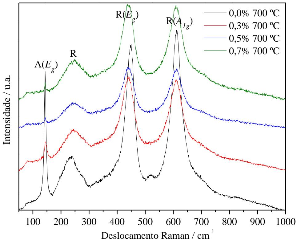
**Figura 16** – Espectros Raman das amostras de  $\text{TiO}_2$  tratadas à  $700\text{ }^{\circ}\text{C}$ .
