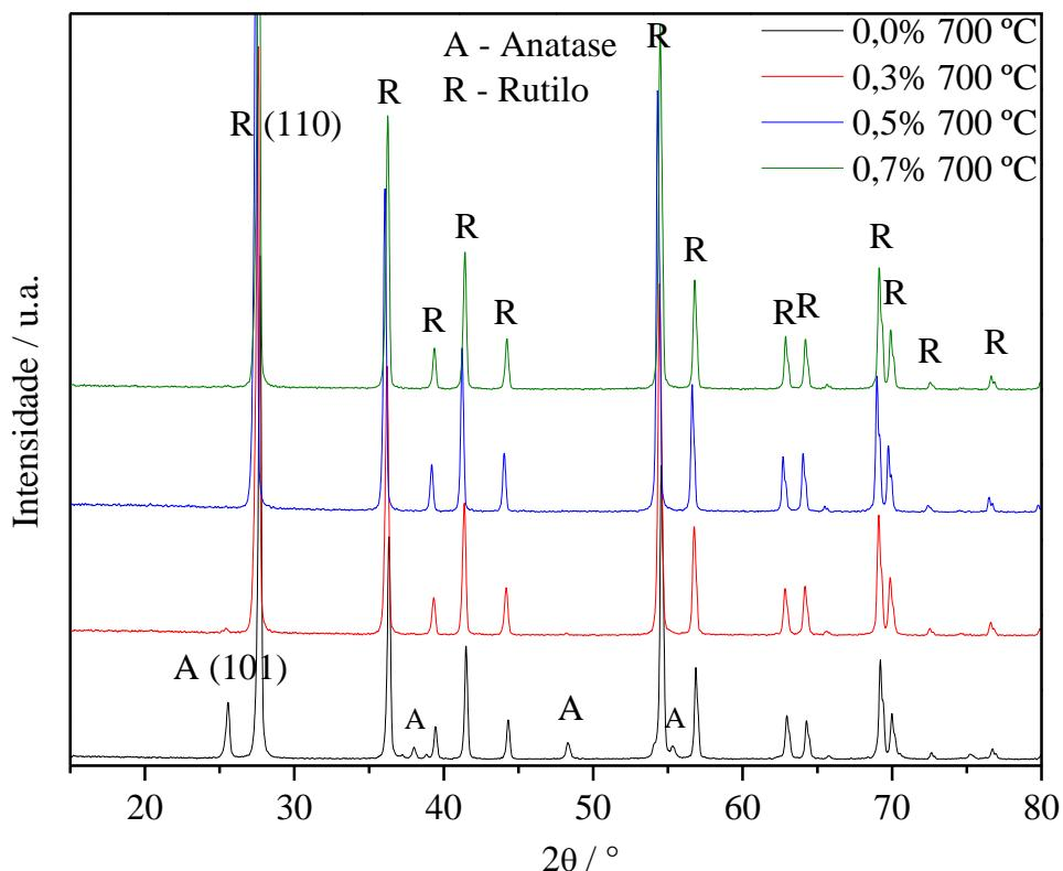
**Figura 13 – Padrões de difração de Raios X das amostras de TiO<sub>2</sub> tratadas à 700 °C.**
