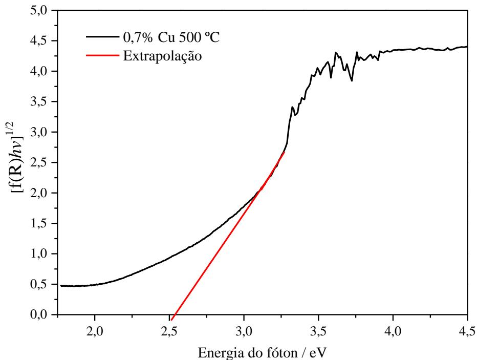
**Figura 18** – Espectro de UV-Vis da amostra  $\text{TiO}_2$  0,7% Cu à 500 °C.
