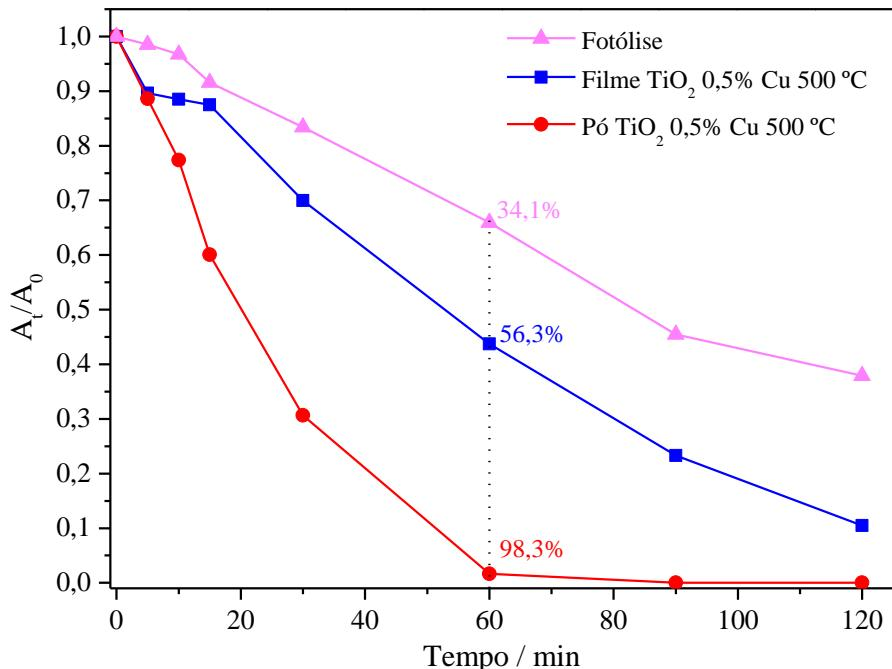
**Figura 37 – Curva de eficiência photocatalítica do filme de  $\text{TiO}_2$  0,5% Cu 500 °C.**
