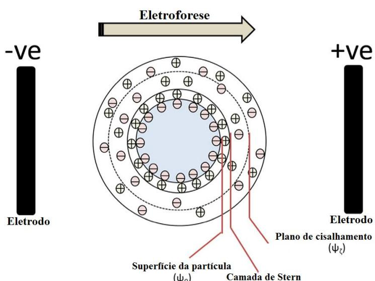
**Figura 6** – Representação da mobilidade eletroforética de uma partícula.
