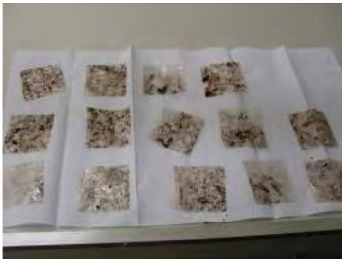
Figura 5: Amostras de polietileno logo após a retirada do sistema de biotratamento.
