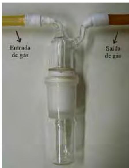
**Figura 6.3:** Vidraria utilizada para colocar as amostras em contato com NO gasoso.
